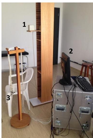
Figura 3: Dispositivo de rastreamento eletromagnético TrakSTAR: 1- Transmissor , 2- Computador com o software MotionMonitor® e 3- Sensores eletromagnéticos de captação de movimento.
