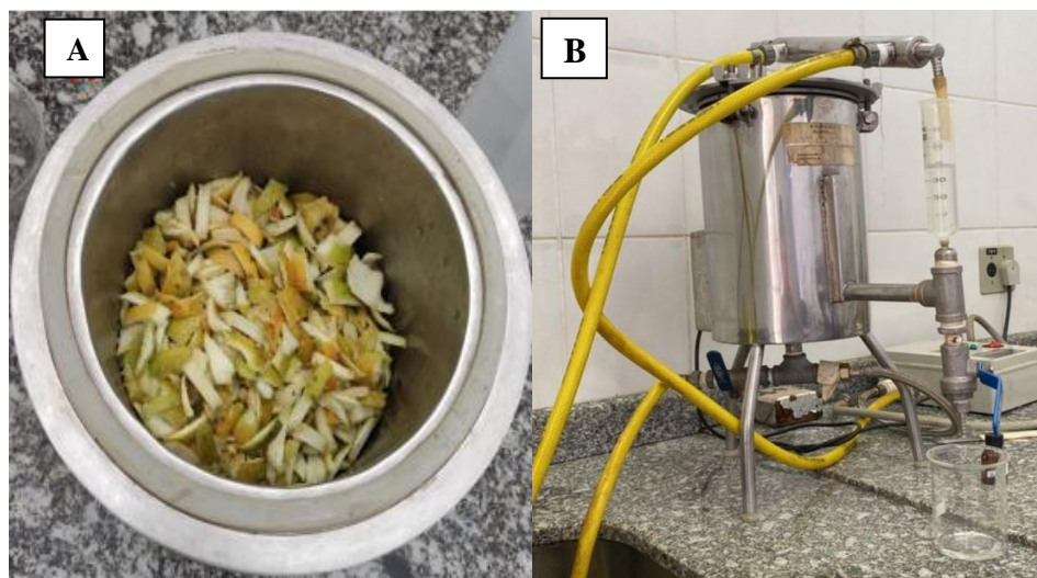
Figura 2. A) Cascas no destilador. B) Aparelho tipo Moritz. Foto: Júlio Cesar S. Ronquim.
