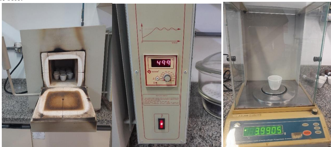
Figura 9 - Método de Calcinação; A. Mufla. B. Temperatura da Mufla. C. Pesagem do cadinho com amostra de solo.
