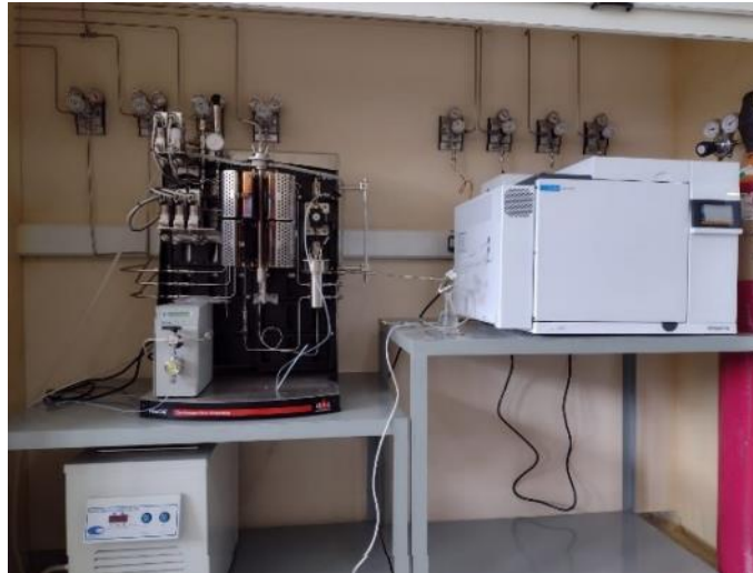
Figura 14. Conexão entre a linha de reação em alta pressão e cromatógrafo.
