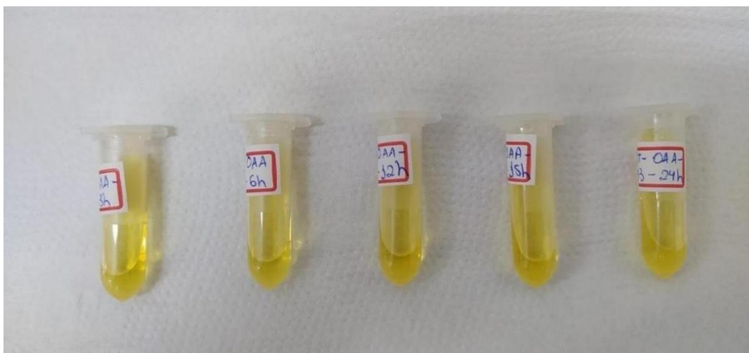
Figura 27: Soluções padrão contendo oxalato de titânio para a quantificação do peróxido de hidrogênio através do método colorimétrico.
