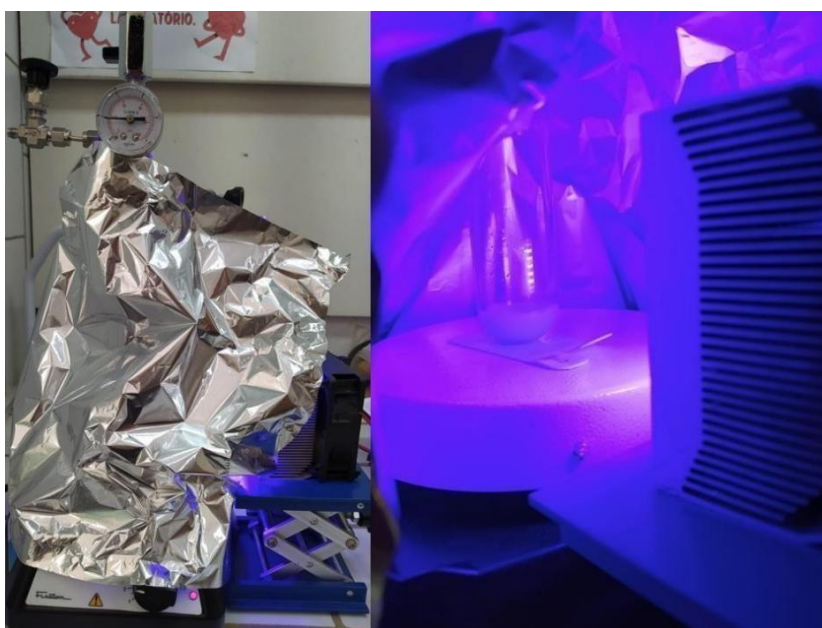
Figura 16: Imagens do sistema reacional utilizado para as reações de foto-oxidação do álcool alílico. Imagem do exterior do sistema (esquerda) e do interior (direita).
