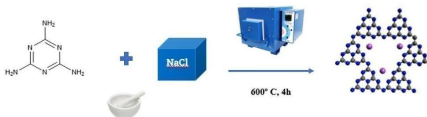
Figura 12: Síntese ionotérmica empregada para obtenção de estruturas PHI de nitretos de carbono. O precursor, melamina, e o sal utilizado NaCl estão na proporção 1:10.
