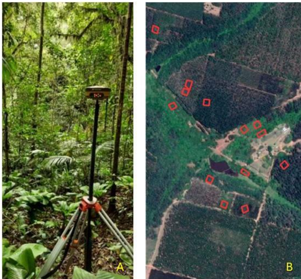
Figura 05. A - Coleta de coordenadas geográficas com GNSS (Sistema Global de Navegação por Satélite); B - Exemplificação de distribuição de parcelas pelo protocolo NewFor.
