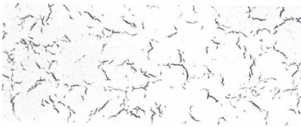
Figura 5 - Plaquetas de hidreto em amostra de Zircaloy 2 livre de tensões.
