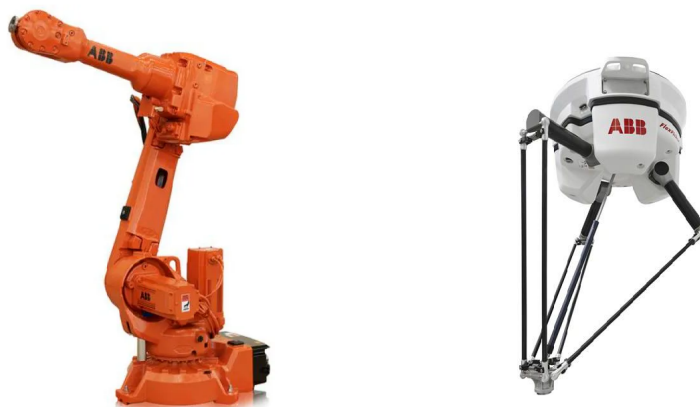
Figura 4 – Exemplo de robô serial e robô paralelo.
