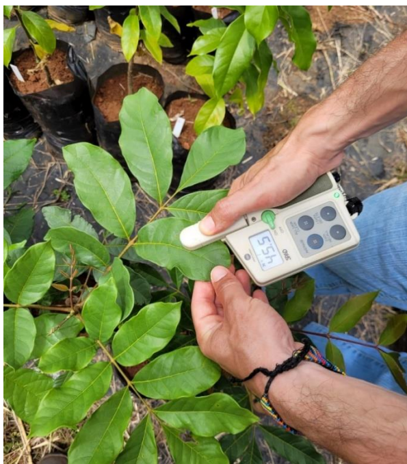
Figura 4: Medição da quantidade de clorofila presente nas folhas de Tapirira guianensis com o SPAD-502Plus.
