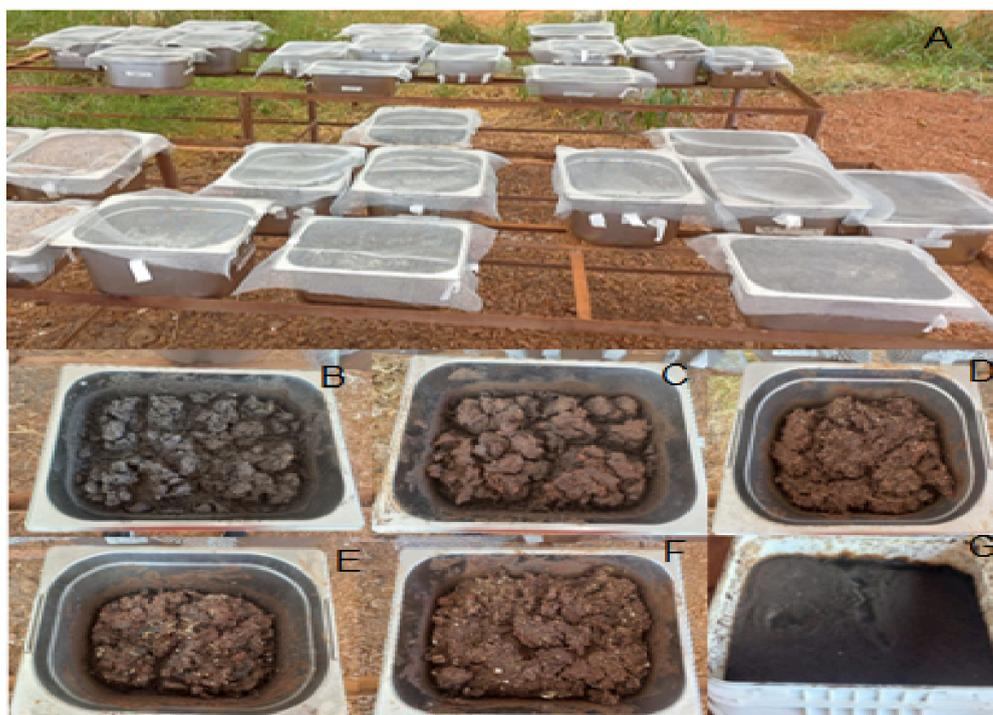
**Figura 2.** Amostras dos diferentes tratamentos dispostas em cubas de aço inox para o experimento de biotransformação. **A:** Amostras montadas; **B:** LE; **C:** LE+S; **D:** LE+S+CA; **E:** LE+S+PL; **F:** LE+S+CA+PL; **G:** LE *in natura* recém coletado (não submetido à biotransformação)
