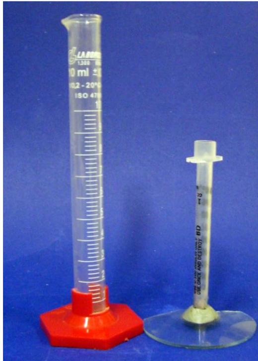
**Figura 9:** Vista geral das provetas de graduação de 1 e 10 ml utilizadas no método volumétrico.
