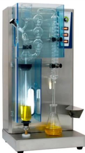
Figura 1 - Representação de um destilador Kjeldahl
