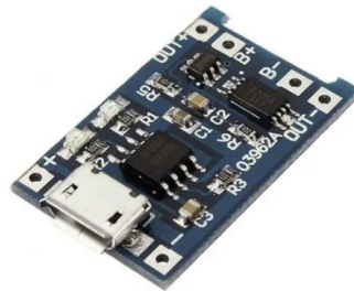
Figura 22 – Placa utilizada para carregamento da bateria
