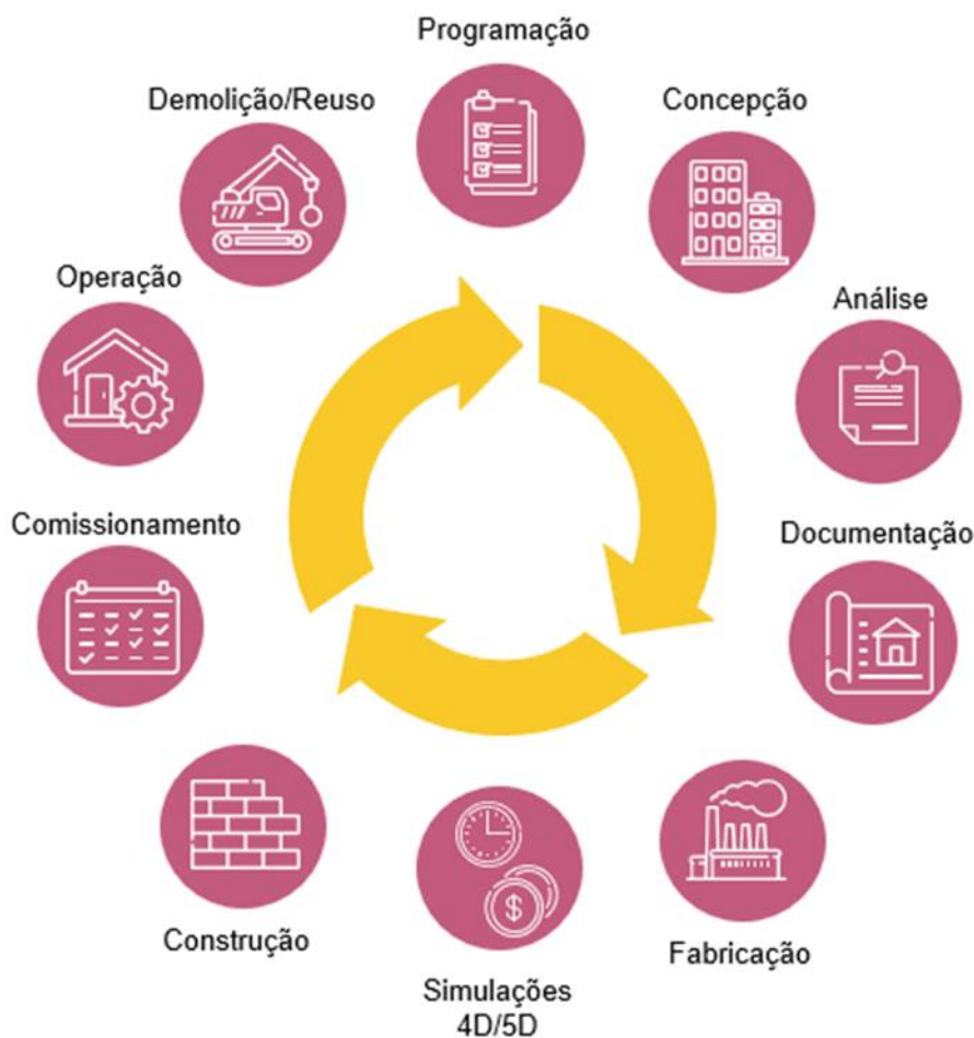
Figura 3-1: BIM no ciclo de vida das edificações
