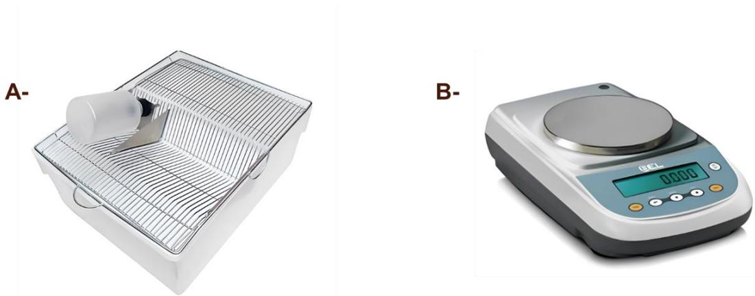
Descrição - A: caixa de polipropileno (41 cm x 34 cm x 17,5 cm) com grade e suporte de água. B: balança eletrônica para pesagem dos animais (em gramas). Fonte: Elaborado pelo autor (2024).
