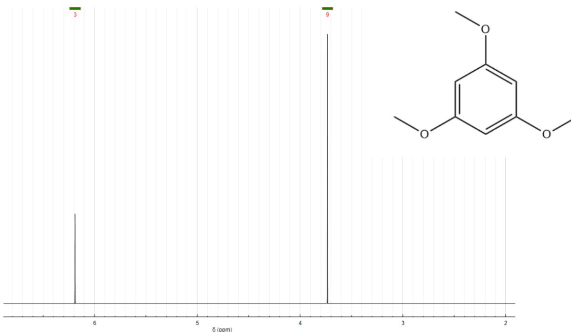
**Figura 4.5** - Espectro previsto de RMN de  $^1\text{H}$  para o 1,3,5-trimetoxibenzeno, TMB, e sua estrutura. Fonte: PATINY, [s.d.].
