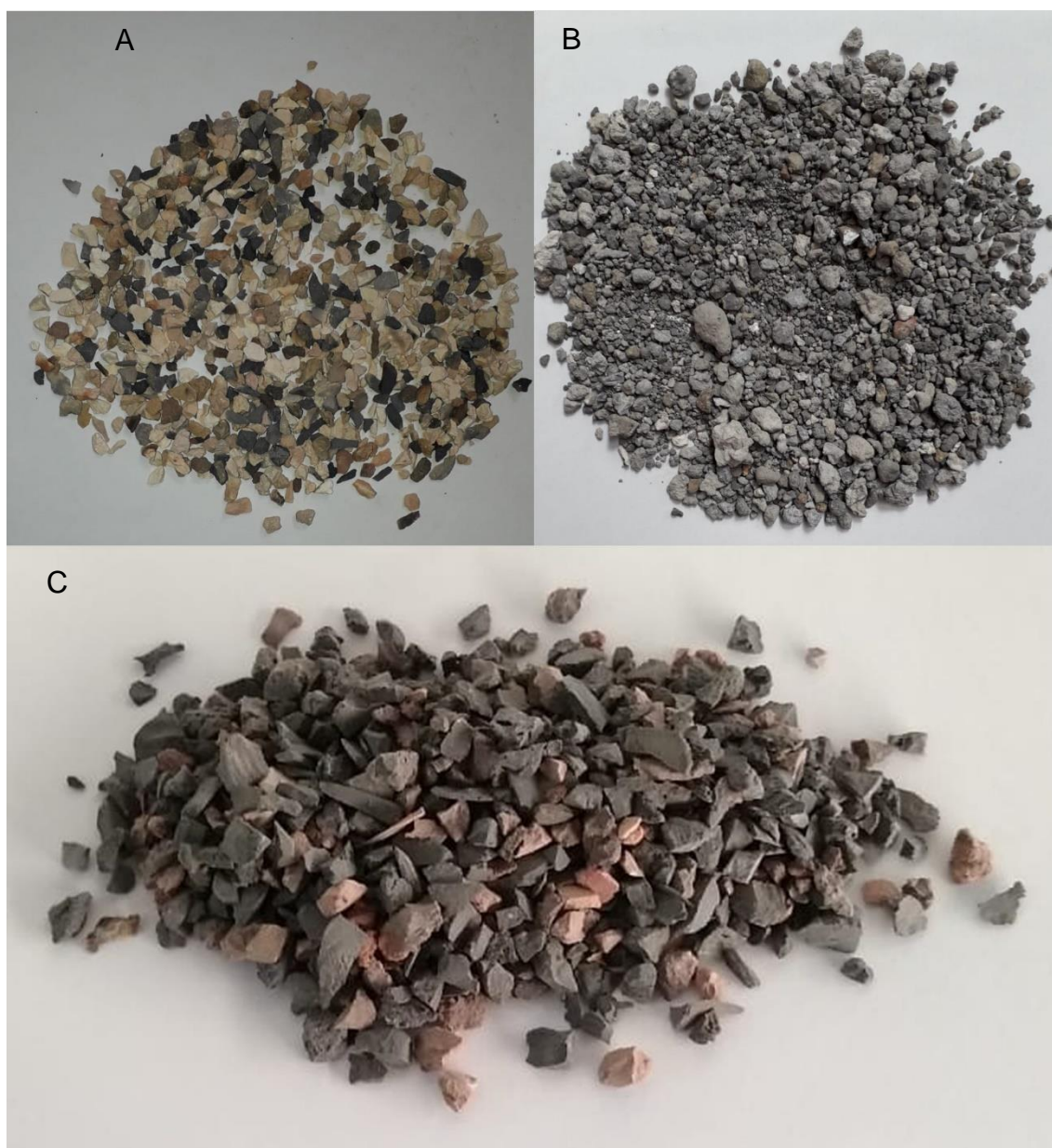
Figura 5-13: Bauxitas Refratárias utilizadas para produção dos corpos de prova. [A] BX CH 90; [B] BX RASC; [C] BAUTEK R-90.
