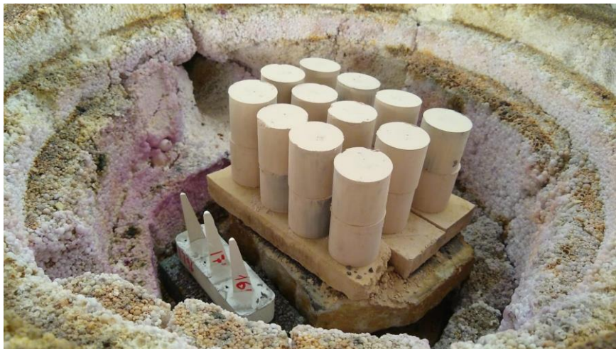
Figura 4-2: Sinterização BAUTEK R-90 escala piloto
