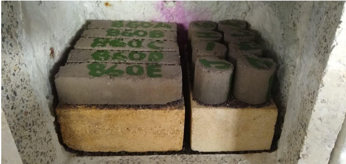
Figura 4-3: Sinterização corpos de prova para os ensaios termomecânicos
