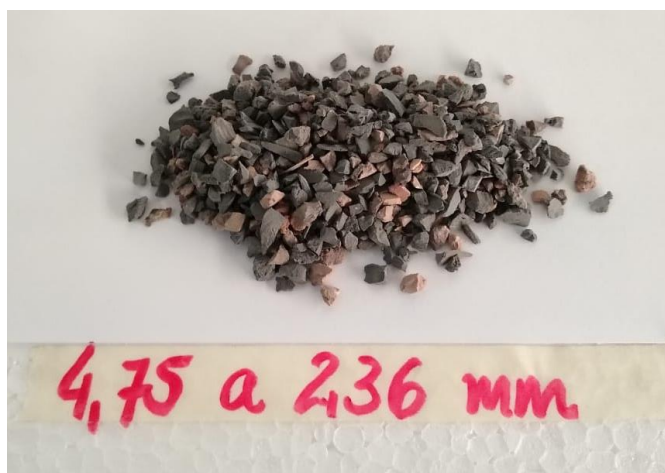
Figura 5-11: Agregado Refratário BAUTEK R-90
