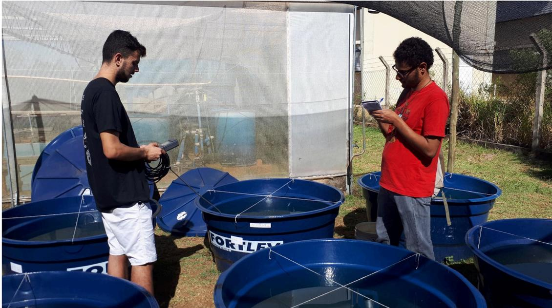
**Figura 3 - Realização das análises físico-química da água através de sonda multiparâmetro Horiba no dia 26/06/2019.**
