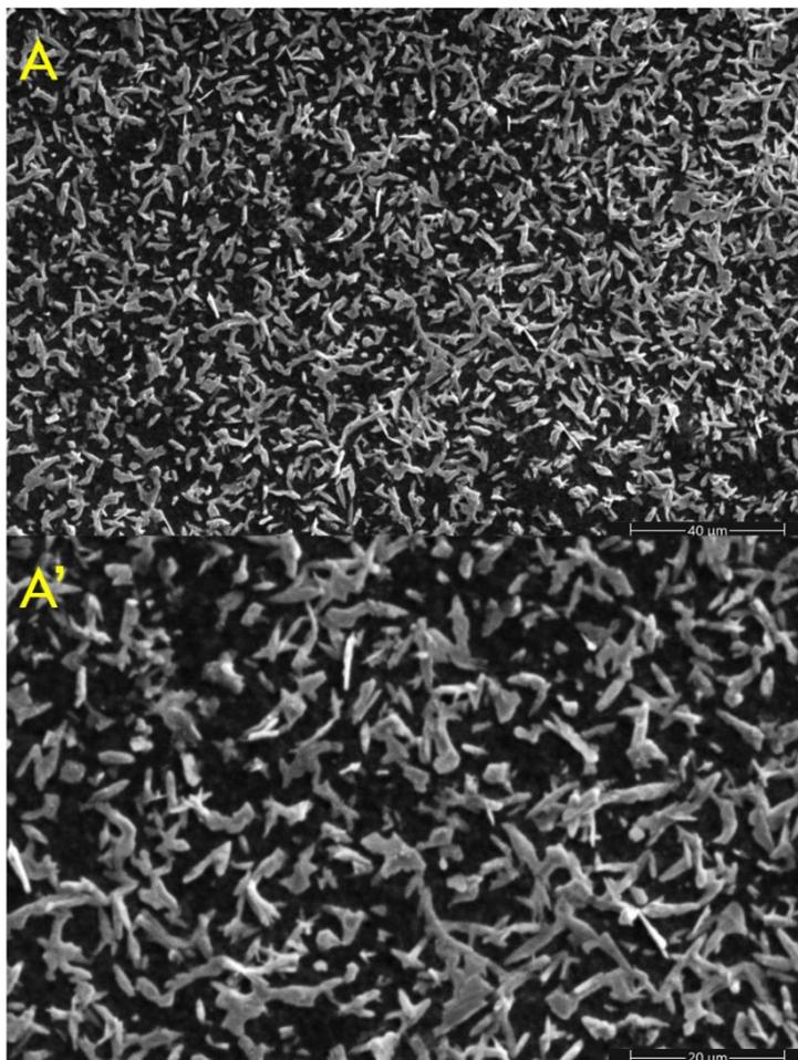
Figura 68. Imagens MEV de Bi/CB-PVA, eletrodepositadas com solução de Bi  $5,0 \text{ mmol L}^{-1}$ , com ampliação de  $1000\times$  (A) e  $2000\times$  (A')
