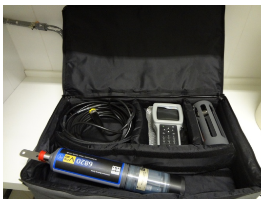
Figura 15: Sonda multiparâmetros YSI 6600. (Foto: Carolina P. Braga, 2012)
