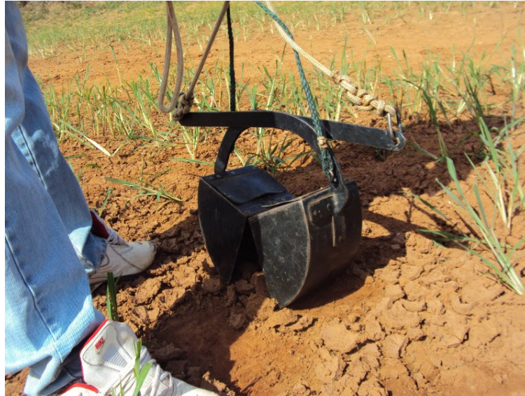
Figura 20: Draga de Van Veen utilizada para coleta de sedimento nas Estações de Piscicultura de Tabatinga e Arealva. (Foto: Giseli Swerts Rocha, 2011).
