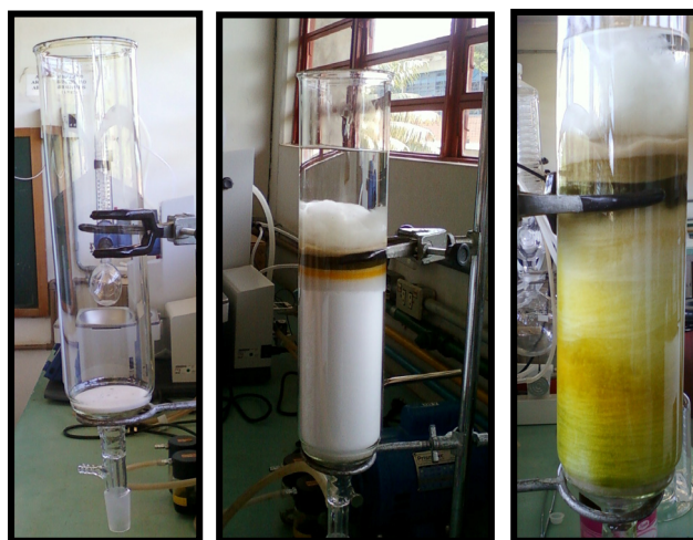
Figura 1. Coluna cromatográfica utilizada para o fracionamento dos extratos de folhas jovens e maduras de Serjania lethalis (Foto: Pereira, V.C. 2012)
