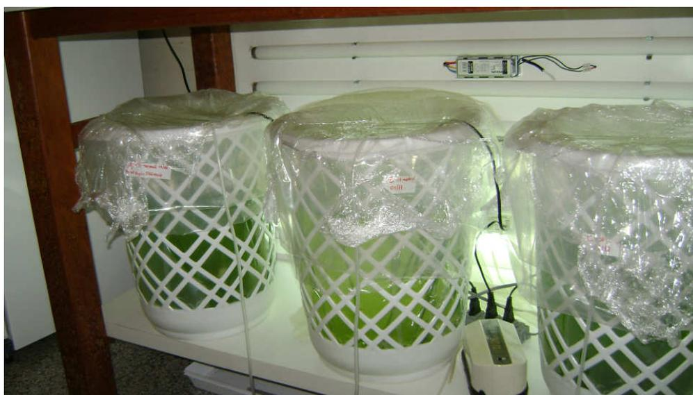
Figura 2. Biorreatores com culturas de *Selenastrum capricornutum*. 1: 20 cm. (MONTANHIM, 2013)
