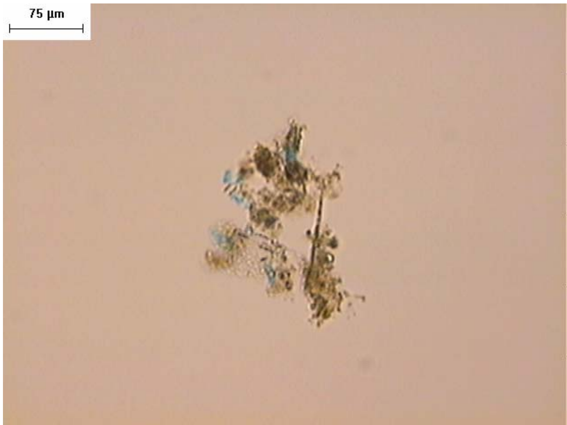
Figura 22: Agregado formado no experimento de agregação na água integral de Barra Bonita, corado com Alcian Blue 0,06 %. Os polissacarídeos ácidos estão corados em azul.
