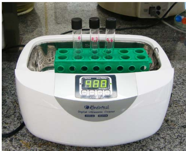
Figura 6. Cuba de ultrassom Digital Ultrasonic Cleaner , modelo CD-4820, produzida pela Kondortech , utilizada para a desagregação de biofilme, com tubos de ensaio contendo as amostras em seu interior
