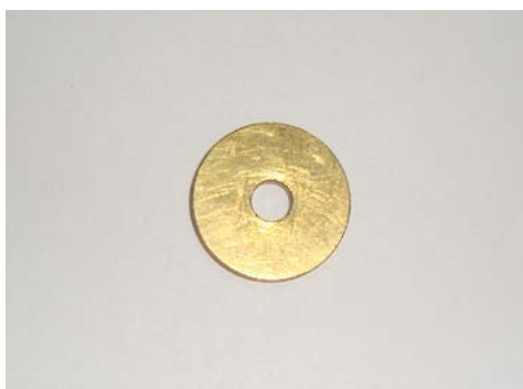
Figura 2. Matriz metálica utilizada na confecção dos espécimes para os ensaios de avaliação da atividade antibacteriana, com orifício central de 4 mm de diâmetro e com 2 mm de altura.
