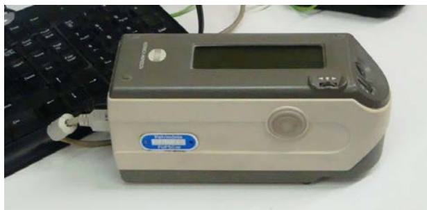
Figura 13. Espectrofotômetro de cor modelo CM-2500D , produzido pela Konica Minolta , usado para medir a cor das amostras dos 3 grupos experimentais.
