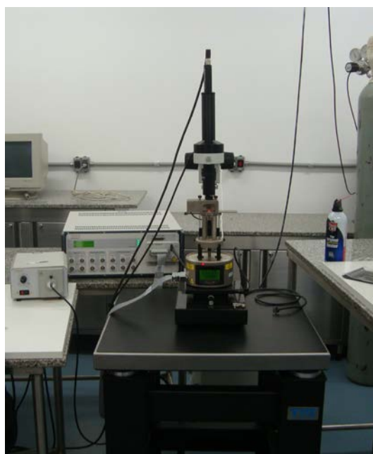
Figura 9. Fotografia do microscópio de força atômica Nanoscope V Multimode , da Bruker , utilizado para medir a rugosidade superficial das amostras de resina.
