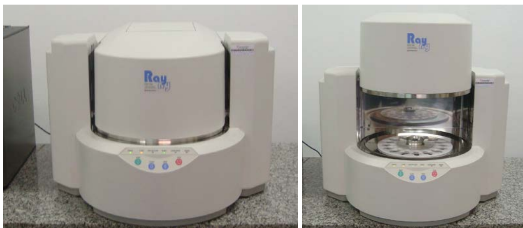
Figura 15. Espectrômetro de fluorescência de raios X, modelo Ray NY EDX – 720 , produzido pela Shimadzu , usado para análise e detecção de elementos químicos em amostras.
