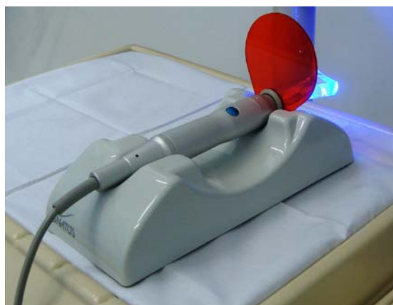
Figura 4. Aparelho fotopolimerizador para resinas compostas odontológicas, do modelo Optilight LD III , produzido pela Gnatus .
