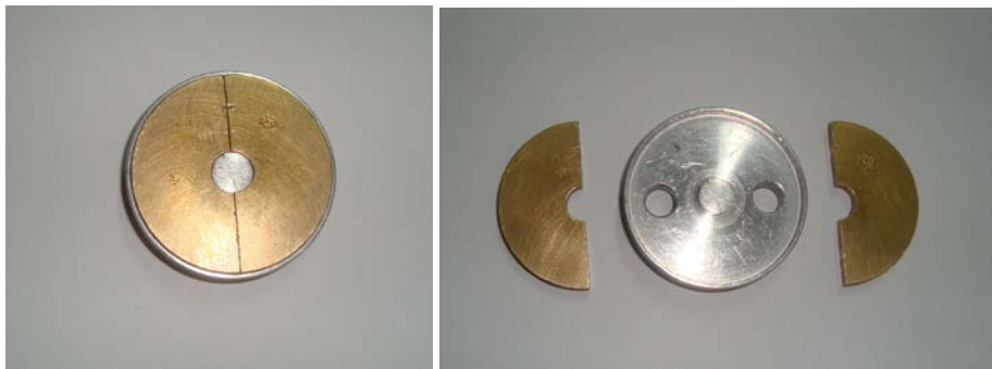
Figura 3. Matriz metálica utilizada na confecção dos espécimes para os ensaios físicos, com orifício central de 10 mm de diâmetro e 1 mm de altura. A parte metálica principal se separa para facilitar a remoção do disco de resina após sua polimerização.
