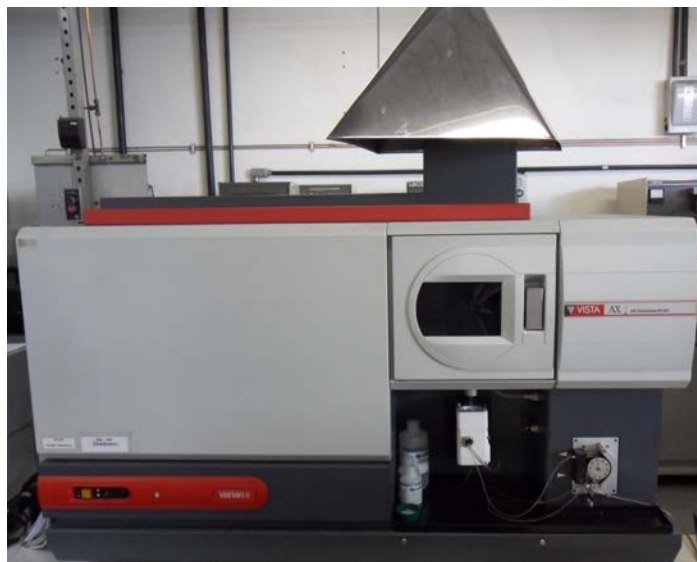
Figura 18. Fotografia do espectrômetro VISTA (Varian) usado para a análise da presença de prata em saliva artificial, possivelmente liberada pelas amostras de resina.
