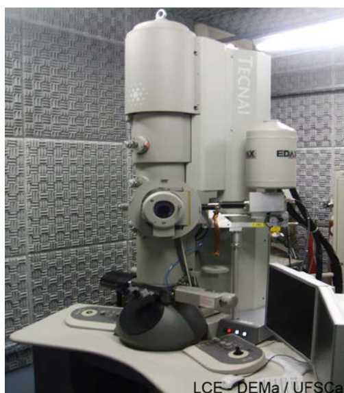
Figura 17. Microscópio eletrônico de transmissão Tecnai/Edax G 2 (FEI Company), usado para análise da distribuição e dispersão de prata nas amostras.
