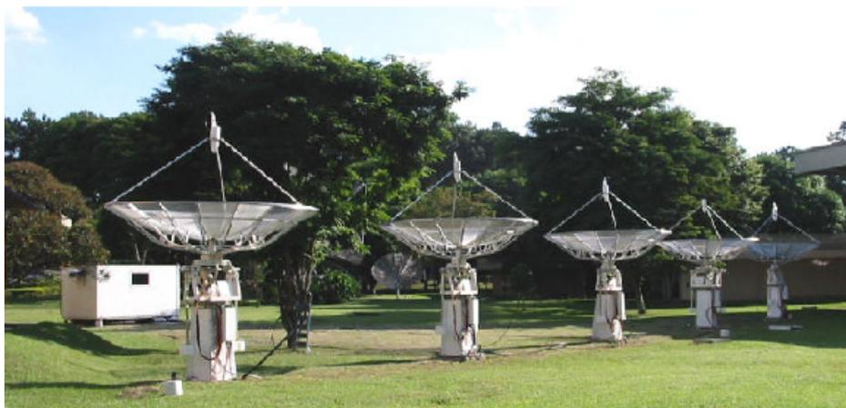
**Figura 2.41: Foto do protótipo do BDA composto por 5 antenas instalado no campus do INPE em São José dos Campos.**
