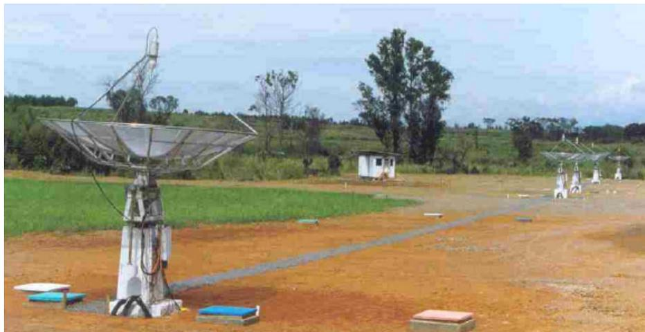
**Figura 2.42: Foto das 5 antenas instaladas no site de Cachoeira Paulista.**
