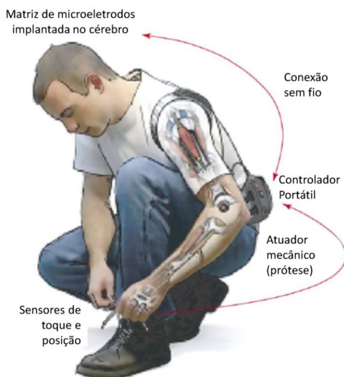
Figura 2.7: Esquema de uma interface homem-máquina. O implante neural é responsável por capturar os sinais do cérebro que são repassados a um controlador que movimenta a prótese. No sentido inverso, informações sensoriais gerados pela prótese são enviadas ao controlador que repassa a informação ao cérebro por meio do implante. Figura adaptada de (LEBEDEV; NICOLELIS, 2006).
