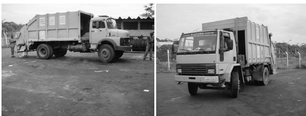
Figura 04: Caminhões compactadores usados para a coleta de lixo domiciliar. O PPT à esquerda e o Ford à direita.
