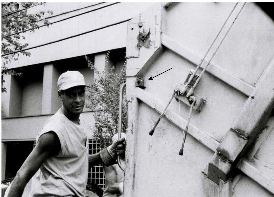
A figura acima mostra as duas alavancas da prensa e o botão de aviso para o motorista, apontado pela seta.
