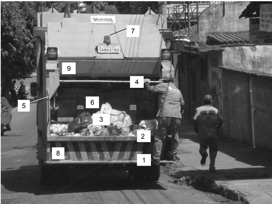
Figura 05: Apontamento das partes do caminhão compactador.
