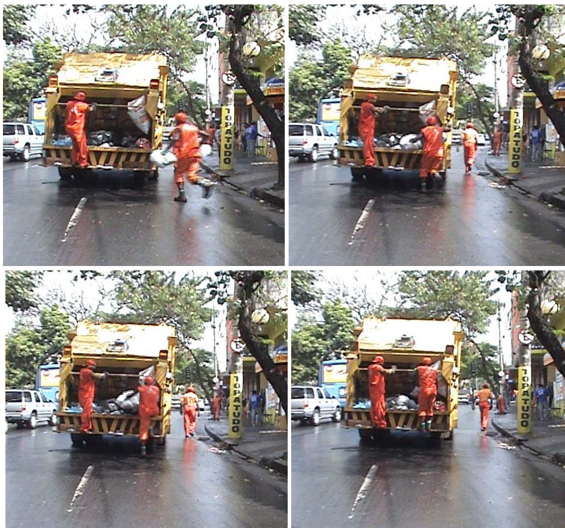
Figura 17: Nesta série de fotos, o gari da direita aproxima-se correndo e sobe no estribo logo após arremessar os sacos de lixo. Na seqüência ele arremessa, sobe no estribo primeiro com o pé direito e depois segura no corrimão central.
