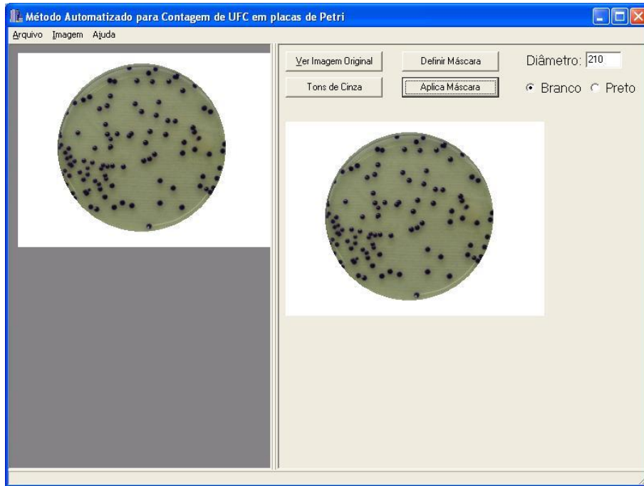
Figura 53: Ação de selecionar a região de interesse. A região foi definida em 210 pixels de diâmetro e definido branco (255) fora da região de interesse.
