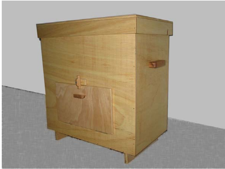
Figura 37: Vista externa do sistema de iluminação. No detalhe a tampa frontal utilizada para a manipulação das amostras.
