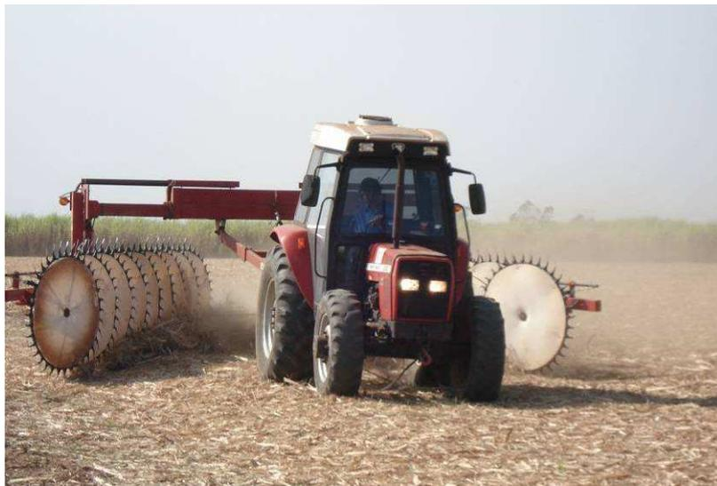
FIGURA 3.7 – Enleiradora de palhicho em operação.
