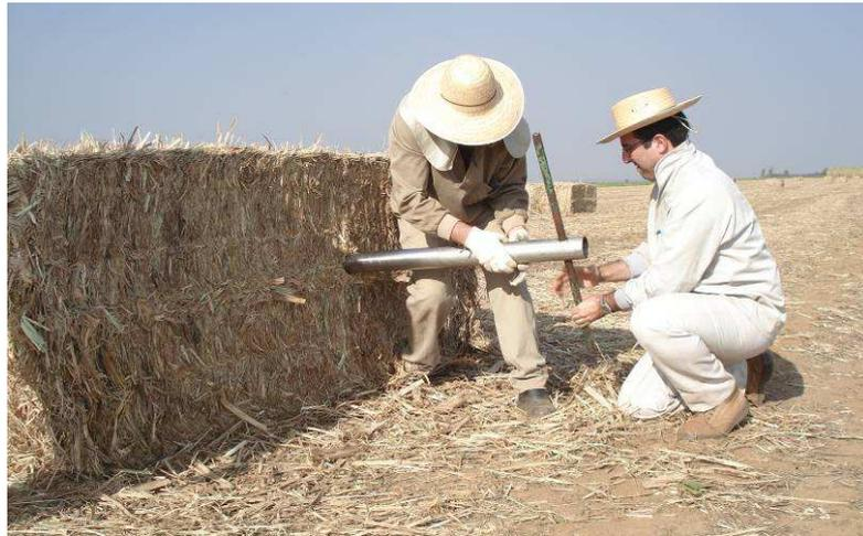
FIGURA 5.32 – Retirada de amostra para realização do ensaio de impurezas e umidade no fardo.
