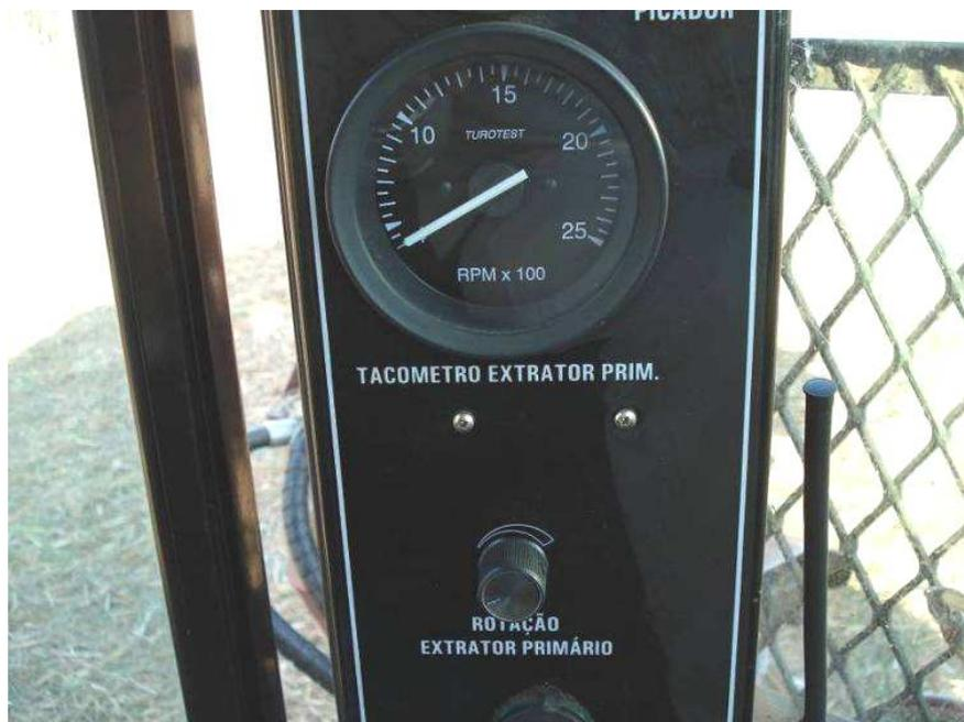
FIGURA 3.5 – Tacômetro e potenciômetro para regulagem da rotação do extrator primário da colhedora.
