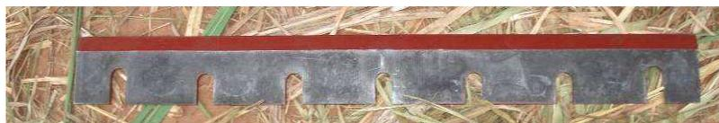
FIGURA 5.4 – Faca para corte da cana em rebolos.
