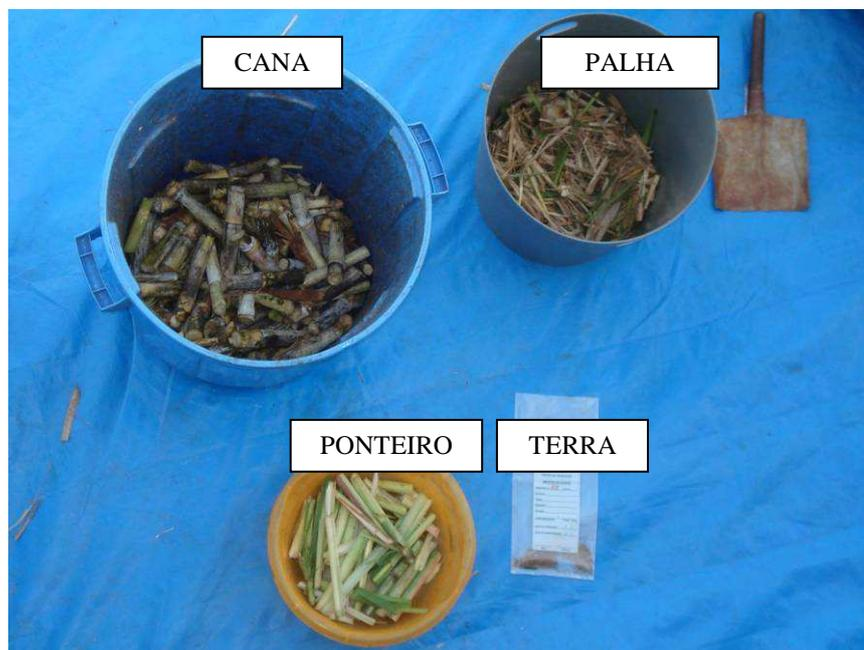
FIGURA 5.15 – Separação da amostra em cana, ponteiro, palha e terra.
