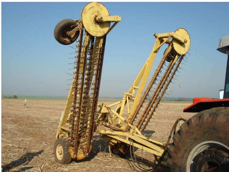
FIGURA 6.6 – Enleiradora de palhico fabricada pela Bowman.
