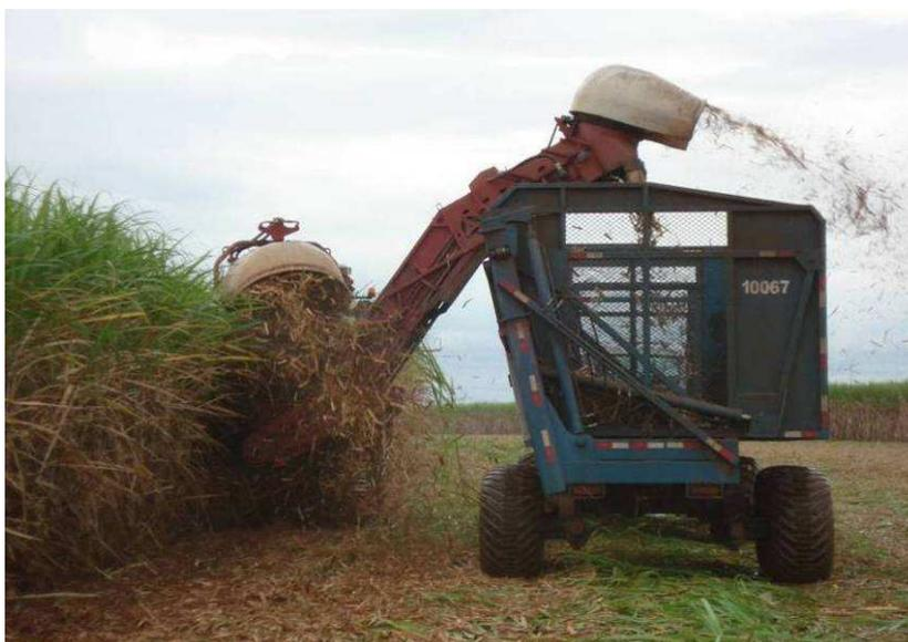
FIGURA 3.6 – Colhedora em operação com extrator primário e secundário acionados.
