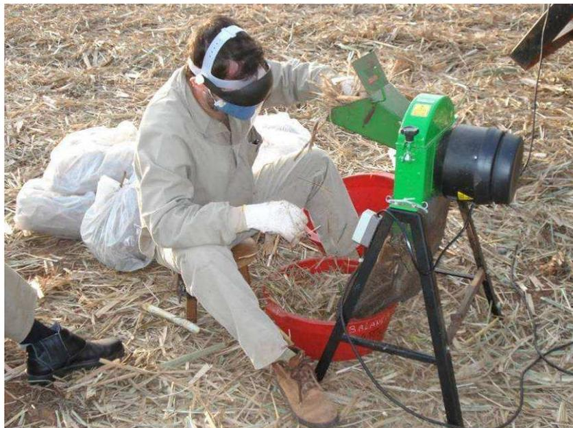
FIGURA 5.16 – Preparação de amostras para determinação de umidade.
