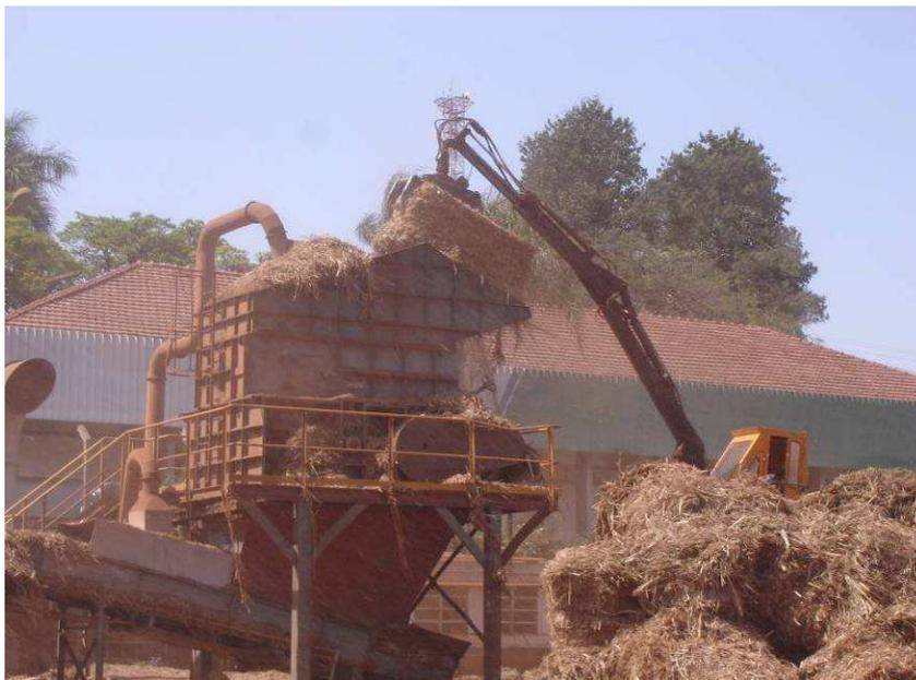
FIGURA 5.25 – Colocação de fardo no equipamento de trituração de fardos.
