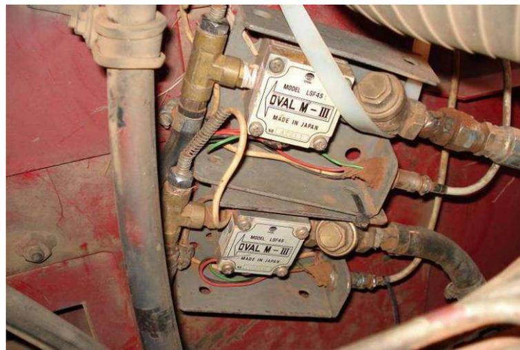
FIGURA 5.10 – Sensores de fluxo para medição do consumo de combustível da colhedora.
