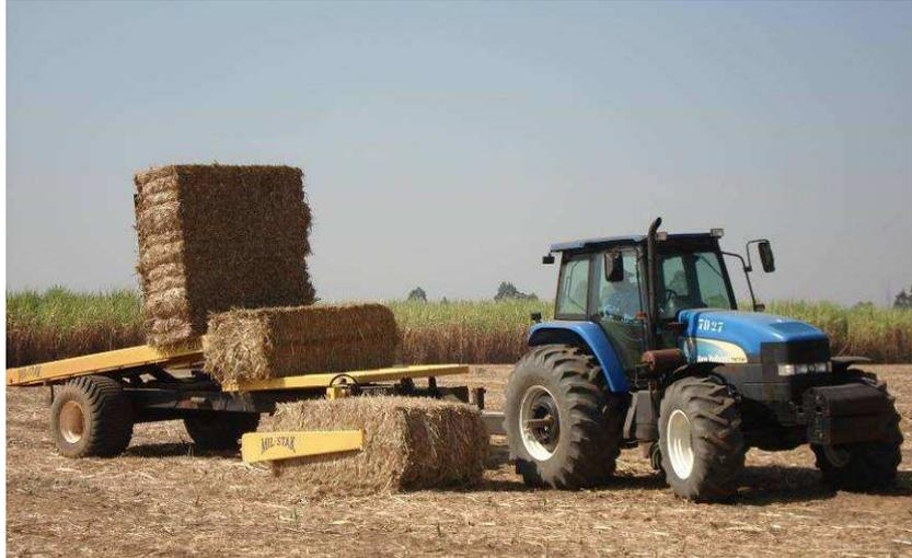
FIGURA 5.29 – Conjunto trator-recolhedor de fardos em operação.
