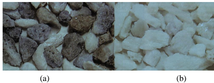
Figura 2.15 - Amostras de ALO branco: (a) grãos rejeitados e (b) grãos de alta qualidade. Fonte: ELFUSA (2011).
