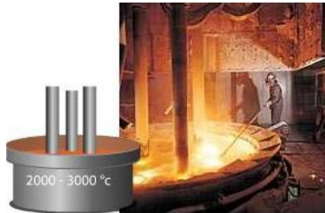
Figura 2.11 - Forno Higgins. Fonte: TREIBACHER (2011)
