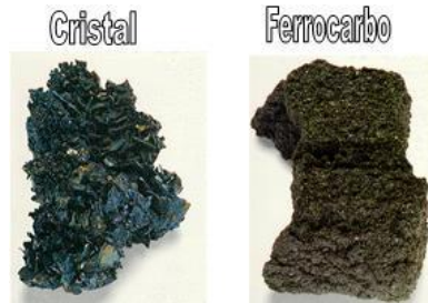
Figura 2.7 - Amostras de carbeto de silício cristalizado e parcialmente cristalizado (Ferrocarbo). Fonte: TREIBACHER (2011)
