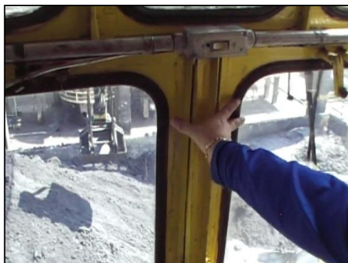
Figura 53 – Viga no painel frontal da Cabine de descoqueamento
