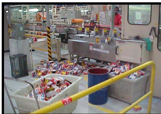
FIGURA 4.11: Cartuchos rejeitados pela máquina
