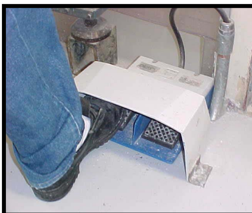
FIGURA 4.9: Sistema de pedais para o acionamento da mesa elevatória
