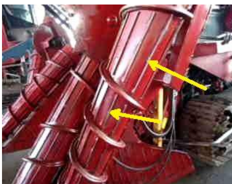
Figura 58. Revestimento nos divisores de linha Case 8800.
