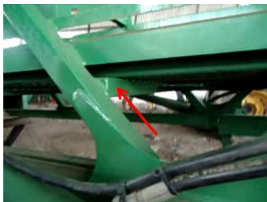
Figura 85. Reforços no elevador John Deere.
