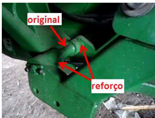
Figure 83. Reforços na estrutura da bandeja John Deere.
