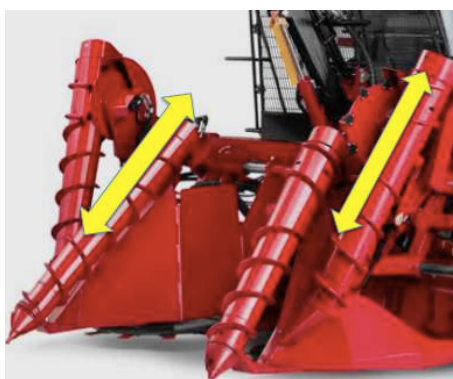
Figure 29. Ajuste dos discos de corte lateral
