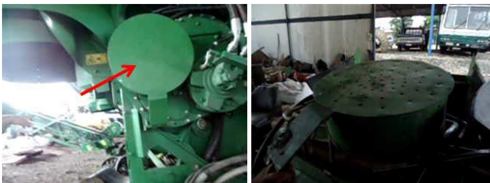
Figura 109. Tampa da embreagem original e furada.
