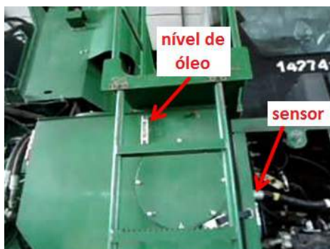
Figura 131. Nível de óleo e posição do sensor original.
