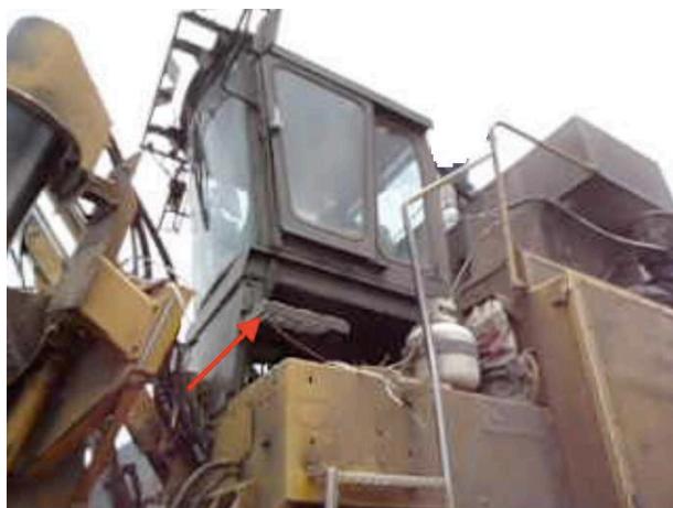
Figura 149. Degrau adicional de acesso à cabine.
