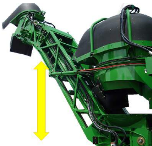
Figura 41. Ajuste da altura do elevador.
