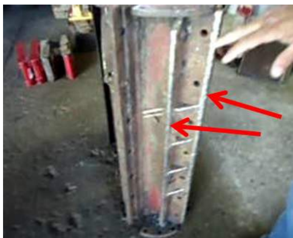
Figura 64. Revestimento dos rolos picadores
