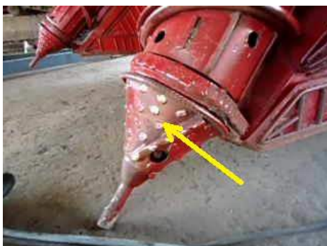
Figura 62. Revestimento da sapata Case 8800.
