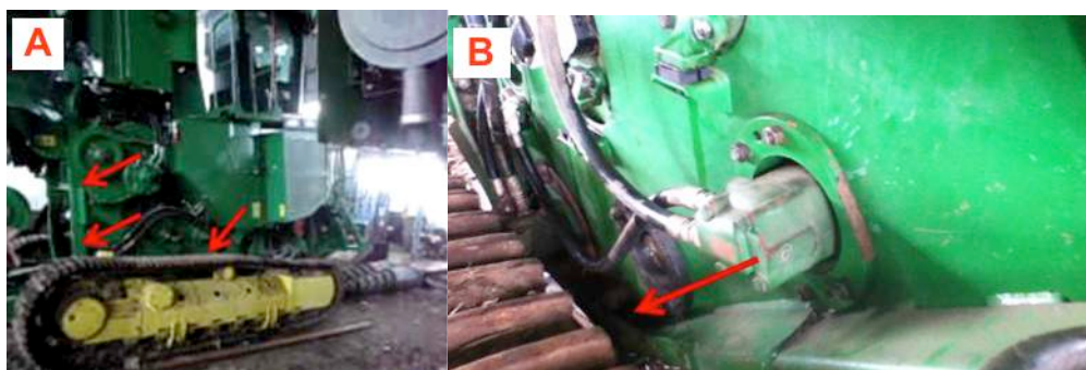
Figura 77. Reforços no chassis John Deere.
