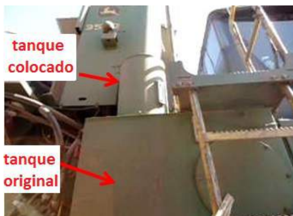
Figura 132. Tanque adicional conectado ao tanque original.
