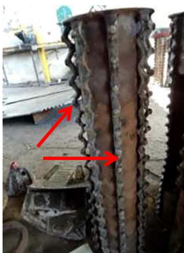
Figura 63. Revestimento dos rolos transportadores
