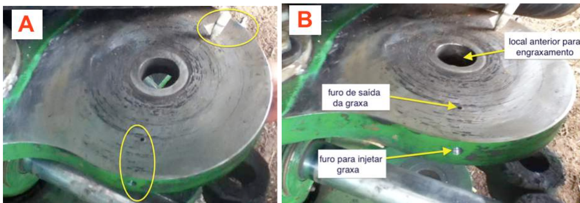
Figura 113. Furos para engraxar a mesa do elevador.
