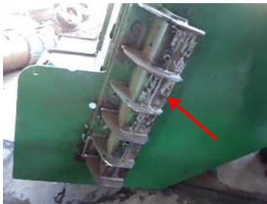
Figura 145. Reforço na estrutura do tanque.
