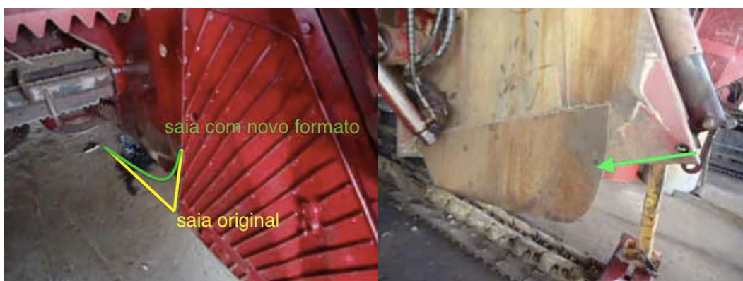
Figura 95. Novo formato da saia flutuante Case 8800.
