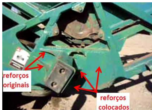
Figura 90. Reforços no batente do elevador.
