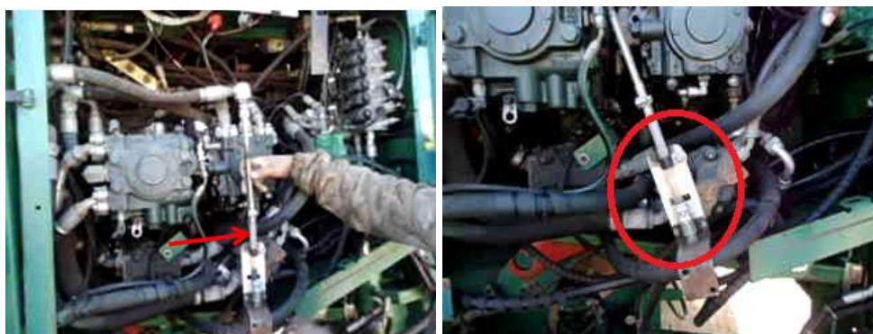
Figura 130. Nova posição do nível de óleo.
