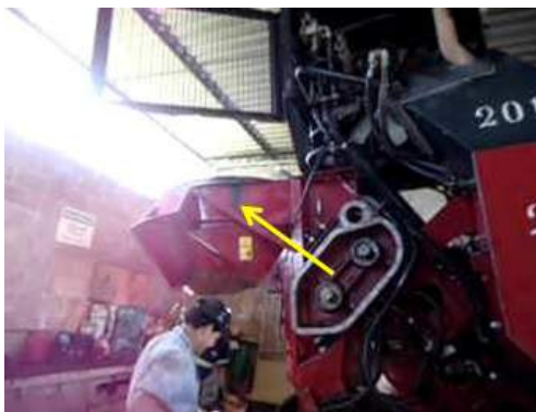
Figura 71. Trinca no anel.
