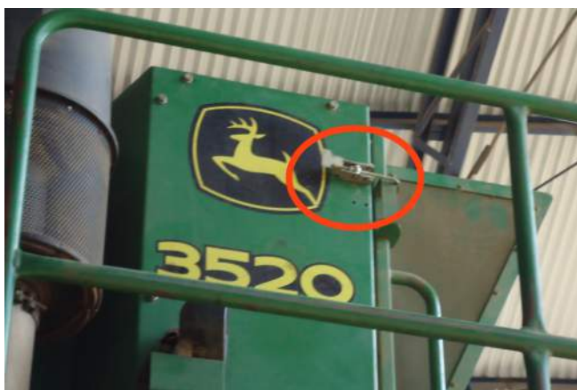
Figura 110. Fechadura da porta do radiador trocada.
