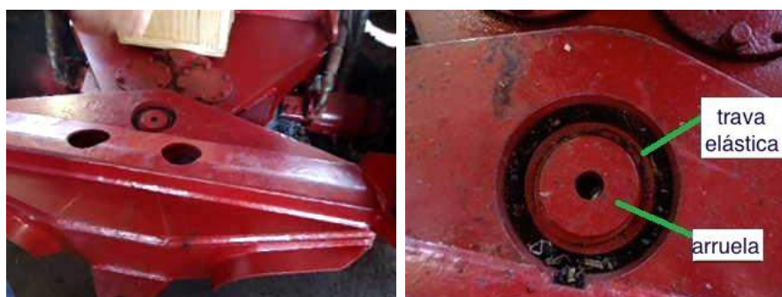
Figura 102. Reforço na mesa do elevador Case 8800.
