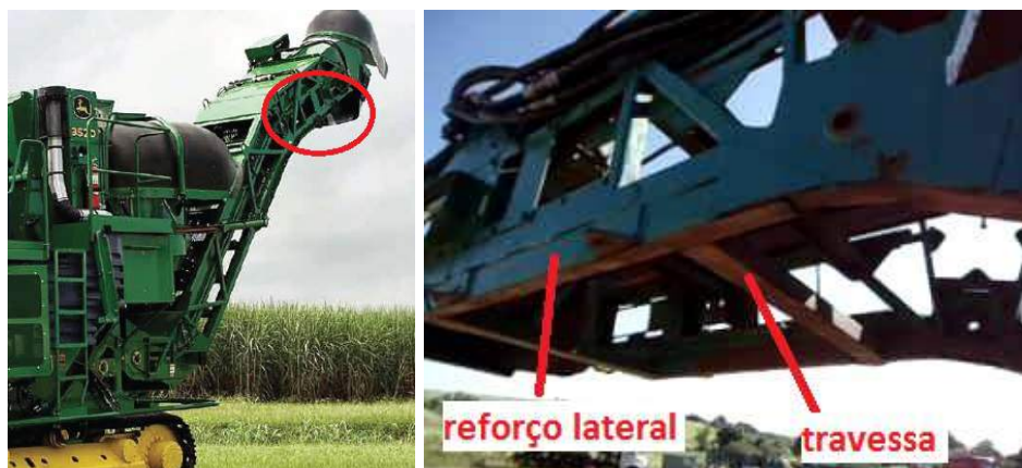
Figura 88. Reforços na porção distal do elevador John Deere.
