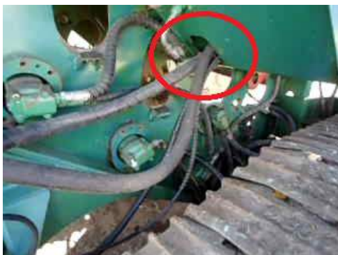
Figura 121. Ponto de atrito das mangueiras.
