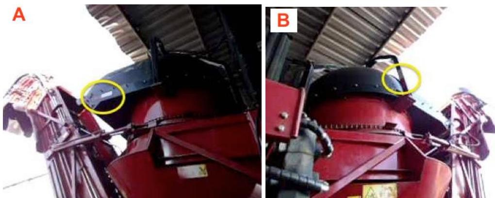
Figura 136. Adesivos refletores no extrator primário.
