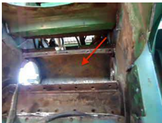
Figura 129. Chapa defletora mais resistente.
