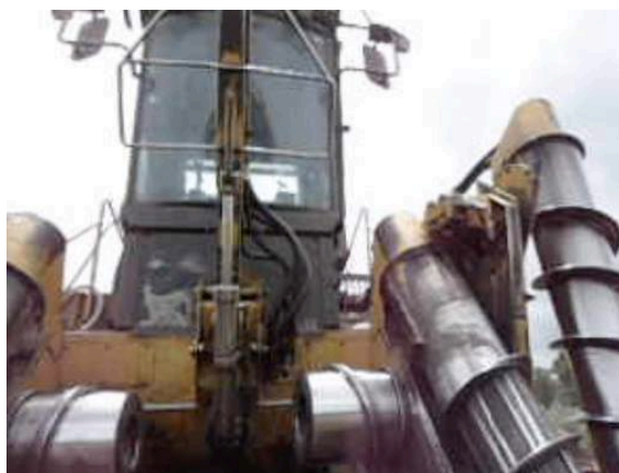
Figura 151. Máquina sem a grade de proteção.
