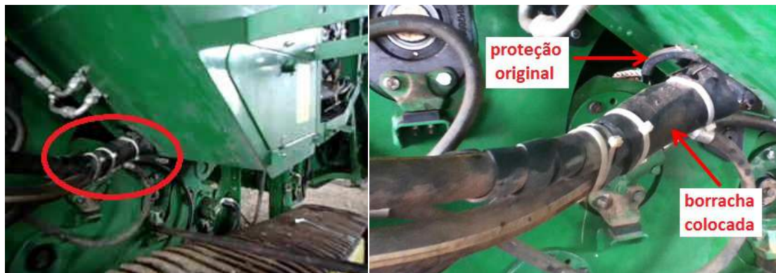
Figura 114. Borracha de proteção envolvendo as mangueiras.
