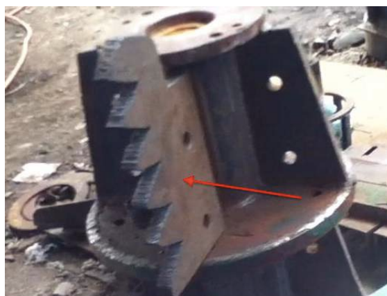
Figura 68. Corte de base - "pé de galinha" fabricado.
