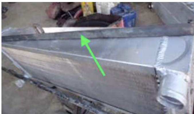
Figura 140. Suporte para manuseio do radiador com a talha.
