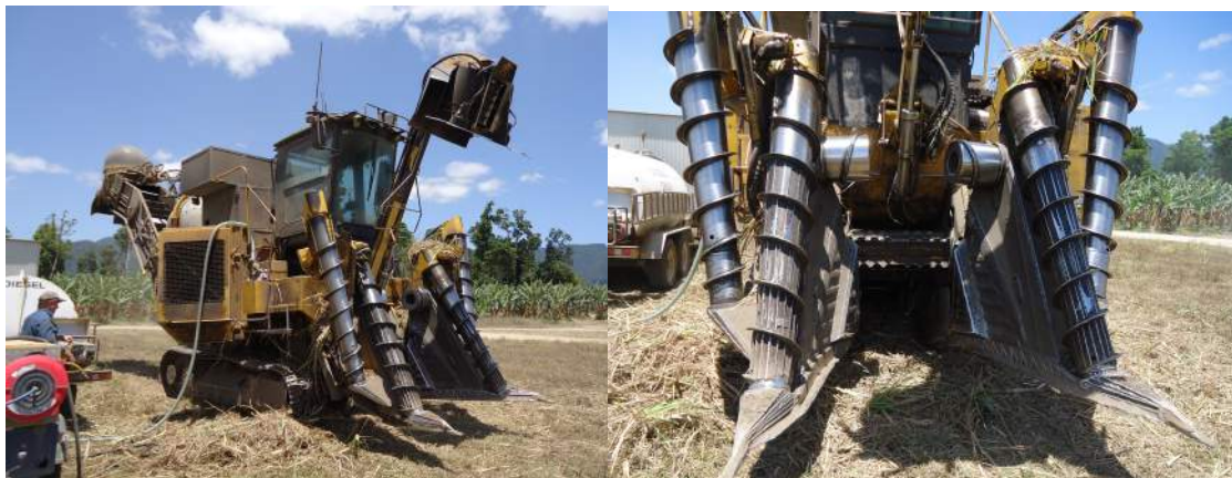
Figura 147. Revestimento de solda na Cameco CH2500.
