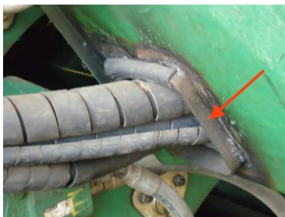
Figura 115. Modificação na saída das mangueiras.
