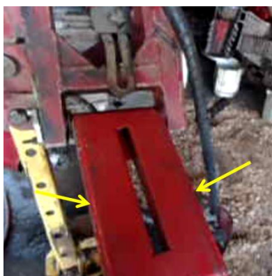
Figura 84. Reforços na estrutura da bandeja Case 8800
