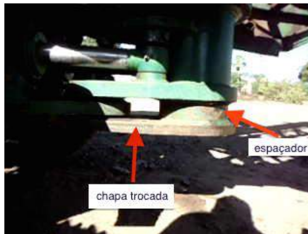
Figura 125. Reforço na mesa do elevador John Deere.
