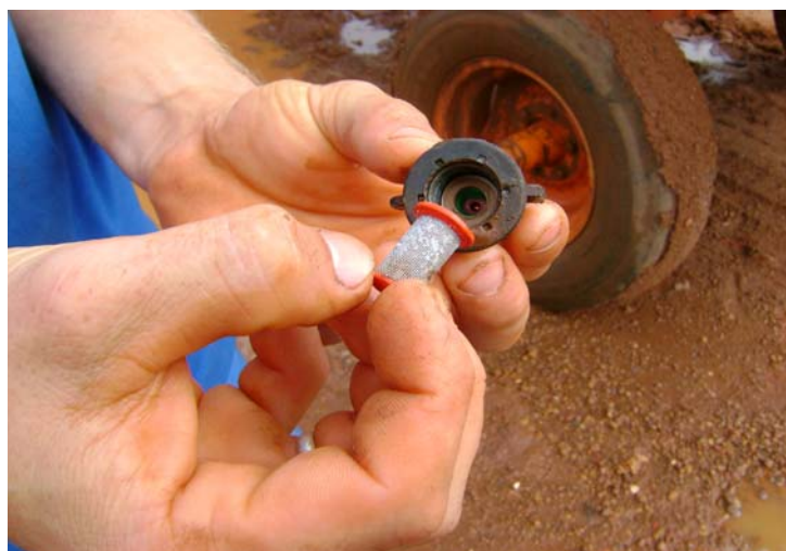
Figura 25: Bico do pulverizador com sujeira, a limpeza é feita, conforme relato, com o uso da boca para soprar na propriedade B no Assentamento Guapirama em Campo Novo do Parecis-MT, novembro de 2008.
