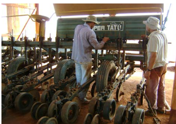
Figura 5: Manutenção e regulagem da plantadeira para o plantio no Assentamento Guapirama em Campo Novo do Parecis, outubro de 2008.
