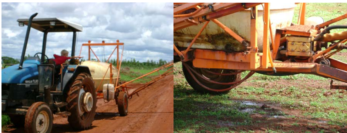
Figura 28: Presença de criança no trator após aplicação e equipamento com corrosão e com vazamento na propriedade C no Assentamento Guapirama em Campo Novo do Parecis-MT, novembro de 2008.
