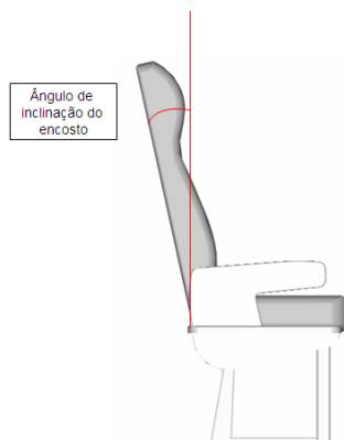
Figura 21 - Ângulo de inclinação do encosto
