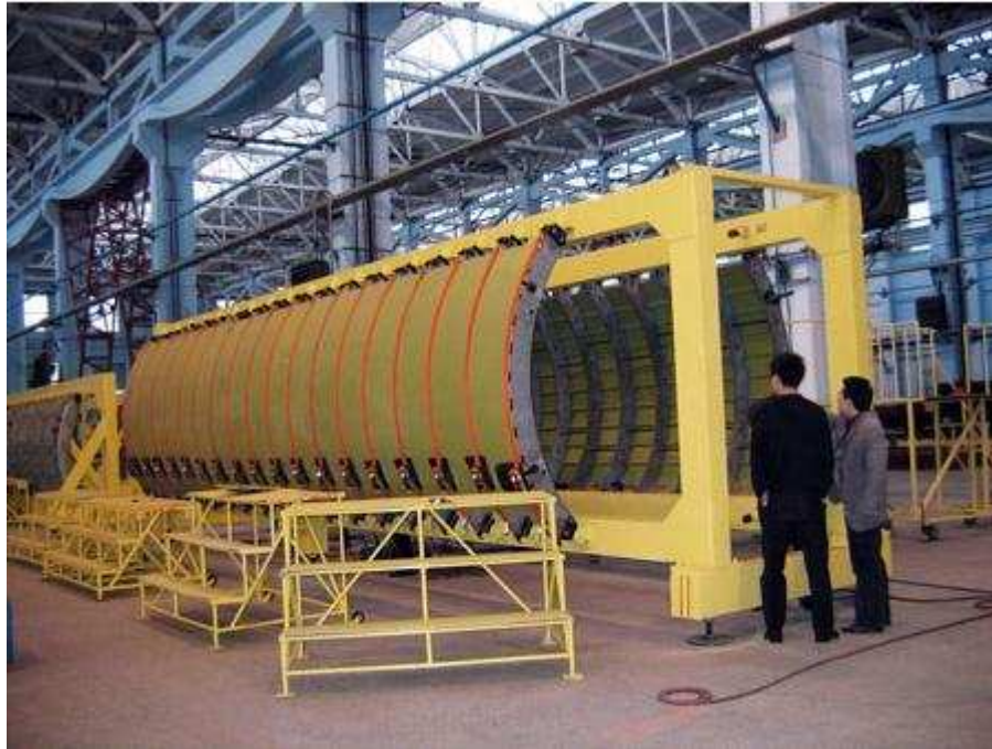
Figura 13: Gabarito flexível, para montagem de painéis (EVOLUTION MAGAZINE, 2006).
