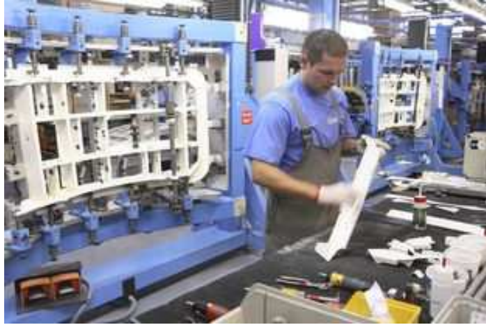
Figura 8: Montador e o respectivo gabarito de montagem de um subconjunto (AERO, 2009).
