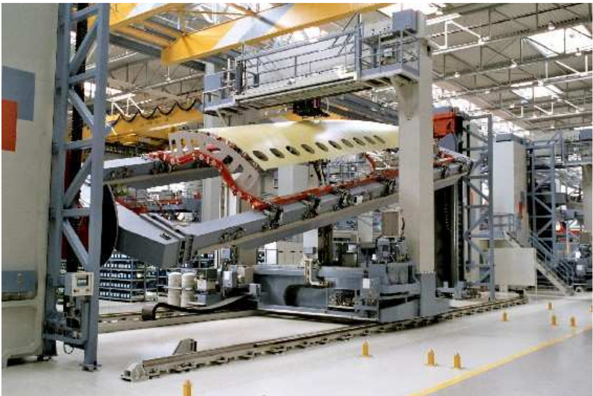
Figura 9: Máquina CNC que faz a rebiteagem de painéis (BRÖTJE, 2009).
