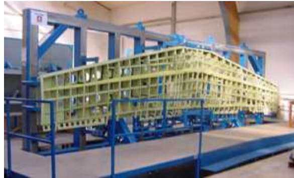
Figura 12: Gabarito dedicado para montagem de um estabilizador horizontal (PILATUS, 2009).
