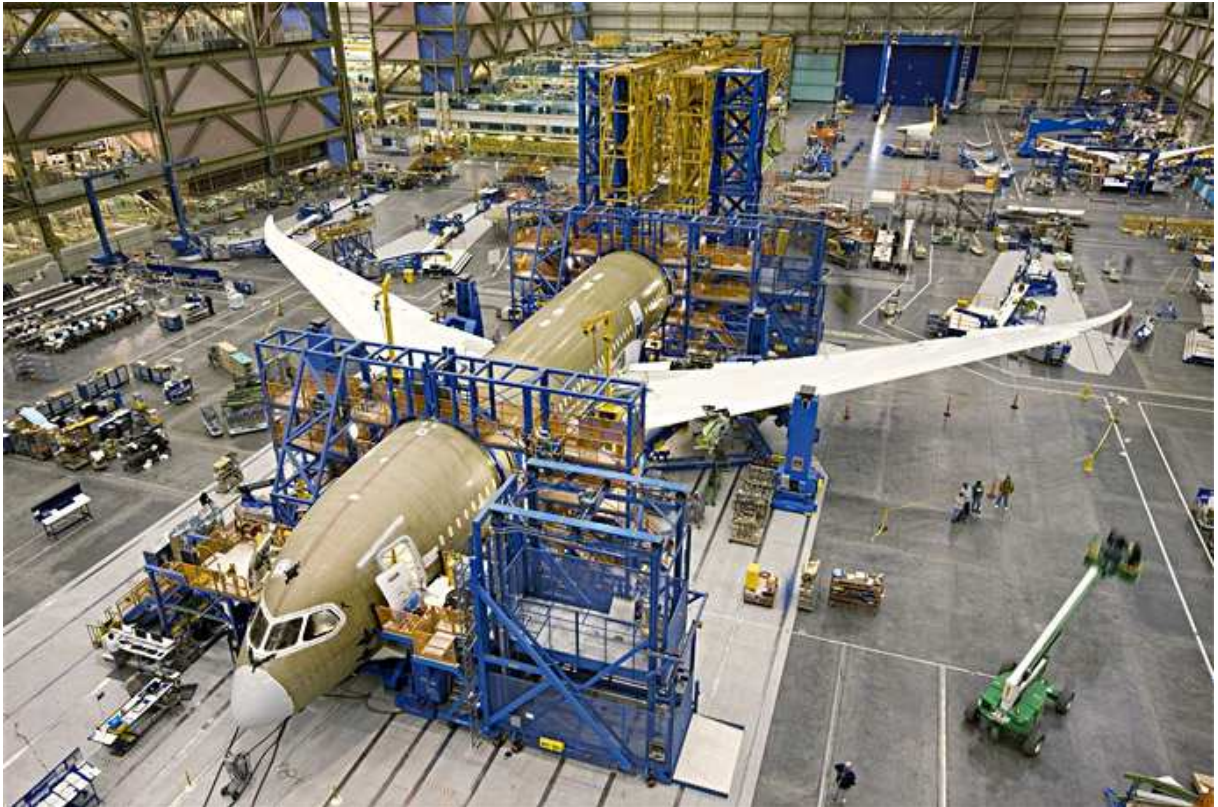
Figura 10: Montagem estrutural de um Boeing 787 (BOEING, 2009).
