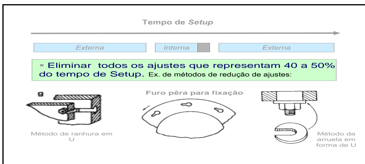
FIGURA 4.18 - Redução de setup interno
