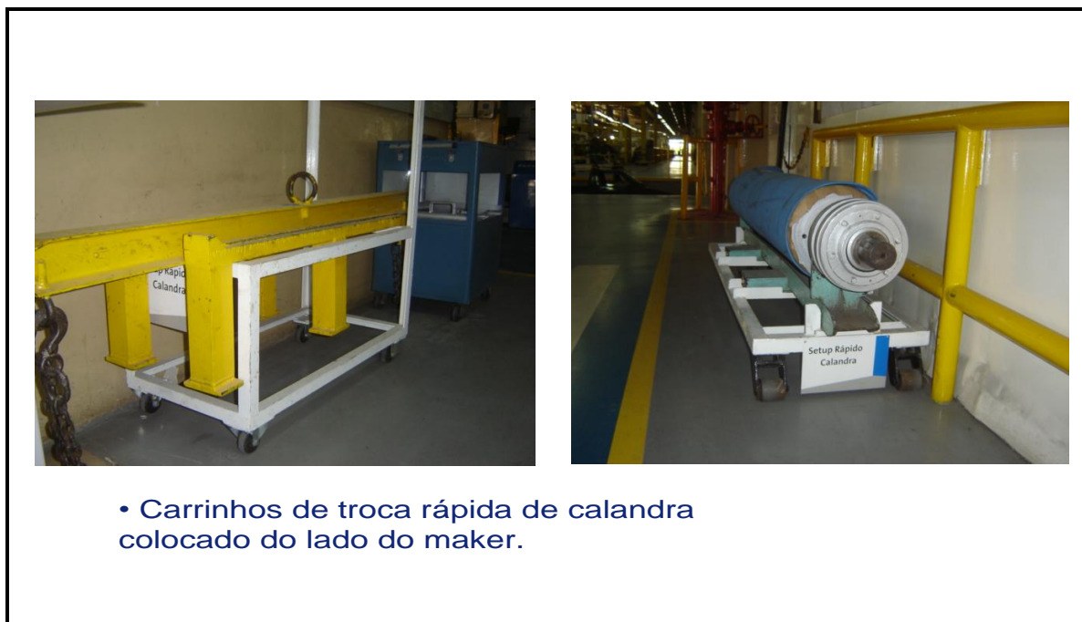
FIGURA 4.23 - Redução do setup interno das calandras FONTE: Empresa C
