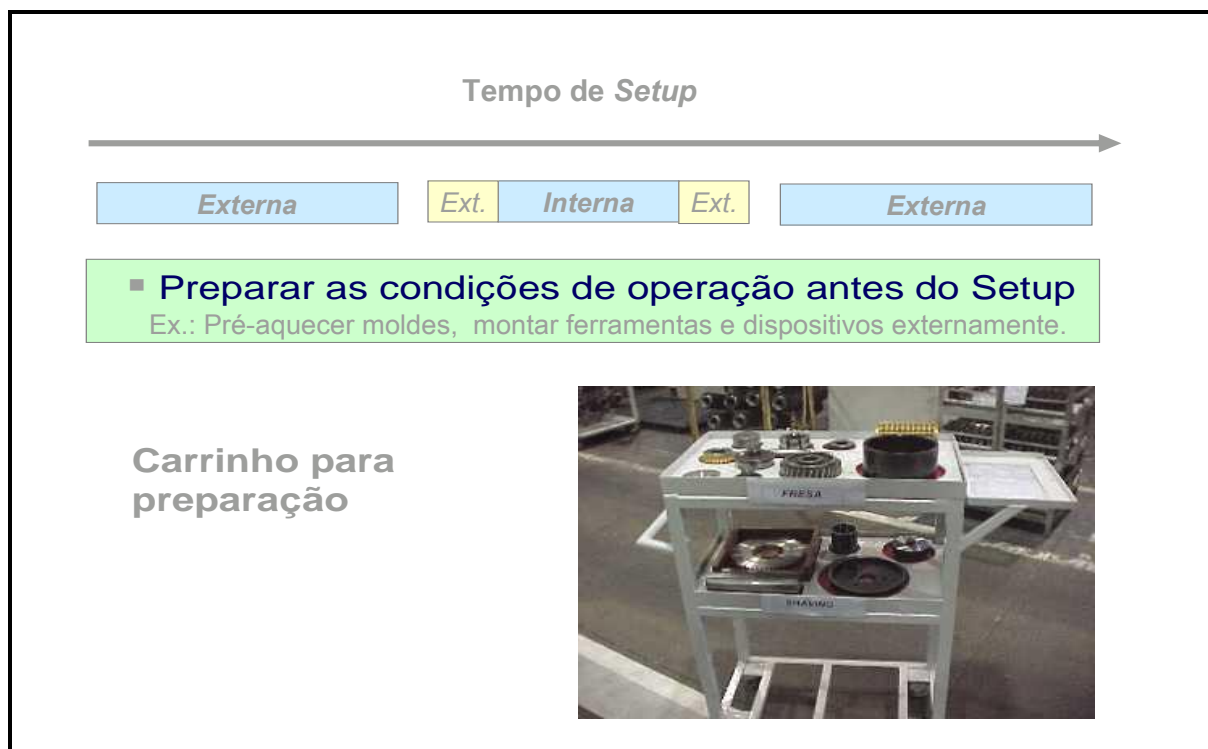
FIGURA 4.17 - Conversão de setup interno em externo
