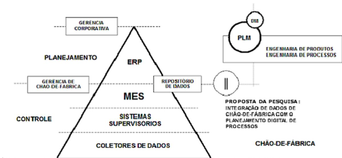
**Figura 2.1** – Hierarquia de camadas adotada pela MESA - MES, ERP e áreas funcionais – Fonte: MESA - Manufacturing Execution System Association (Adaptado).
