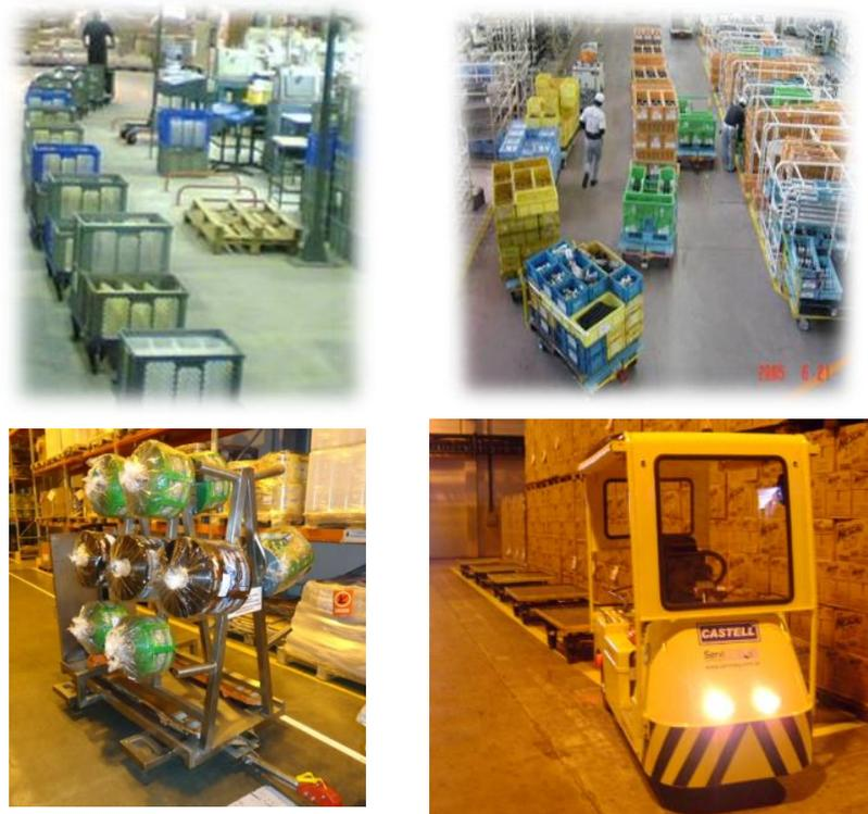
Figura 2.10 – Exemplos de trem para *milk run* interno
