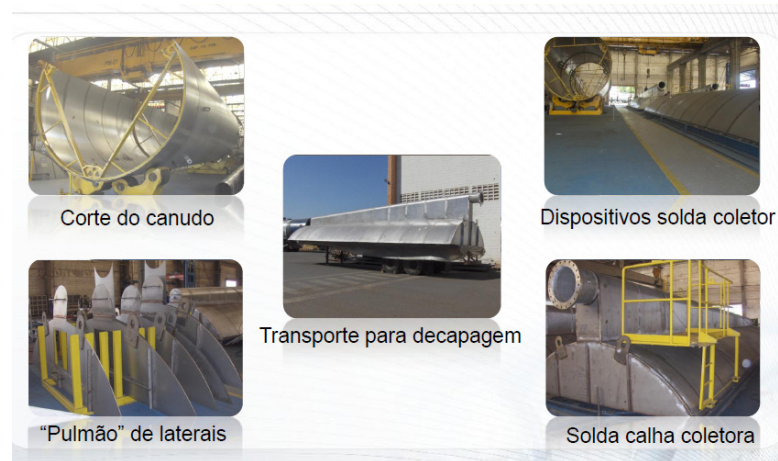
Figura 8: Algumas etapas da montagem do captador de caldo, que possibilitaram a discussão dos trabalhadores para kaizen
