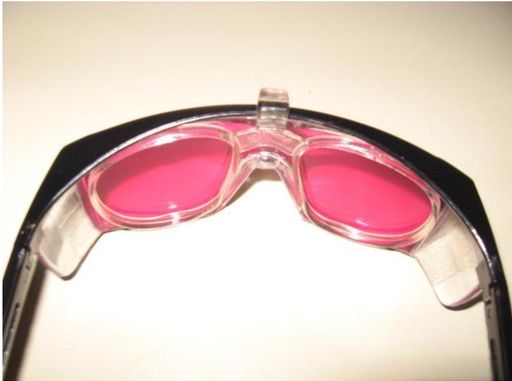
Figura 40 – Filtro #43 fixado mecanicamente a um óculos de segurança por meio de um clip. Fonte: ARANTES, 2011.
