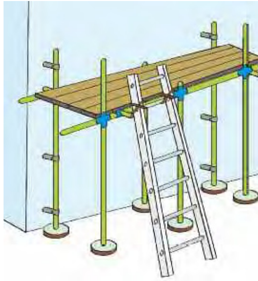
Figura 16. Fixação dos pontos de apoio da escada ao objeto.
