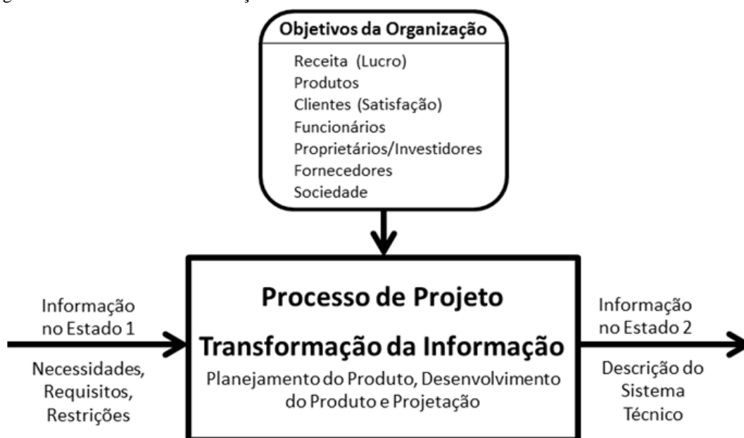
Figura 5-1: Modelo de transformação de sistemas técnicos
