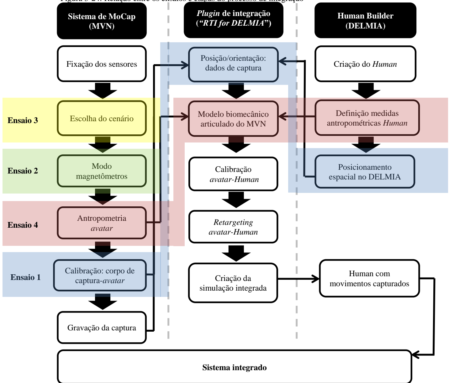
Figura 3-24: Relação entre os ensaios e etapas do processo de integração
