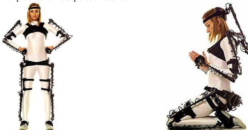
Figura 2-12: Exemplo sistema MoCap eletromecânico
