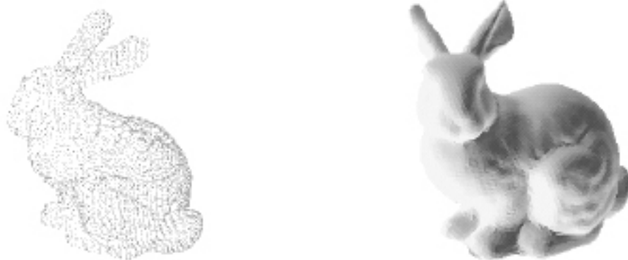
Figura 26: Resultados da reconstrução da nuvem de pontos do coelho de Stanford. Foi utilizado um SOM com formato da grade esférico, baseado na subdivisão do icosaedro. (a) nuvem de pontos; (b) superfícies reconstruída. Fonte: (YU, 1999).
