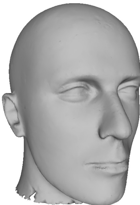
Figura 49: Resultado da reconstrução da nuvem de pontos de uma cabeça humana, com 41.117 pontos. A malha poligonal foi gerada com 40.000 vértices.
