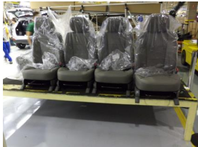
Figura 4.9 Bancos do SN reposicionados em dispositivo para o sideline
