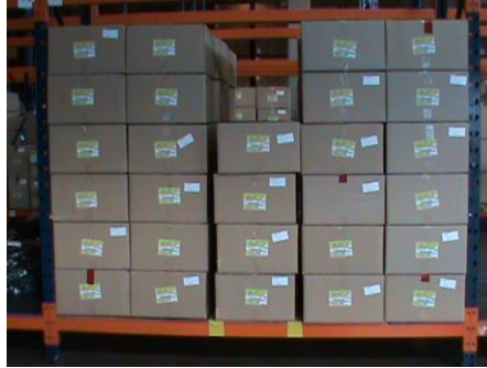
Figura 5.17 Capacidade sobrecarregada do flow-rack da sub-estação Para-choque
