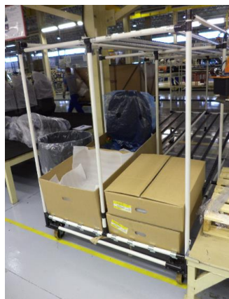
Figura 4.10 Bancos do SX reposicionados em dispositivo para o sideline
