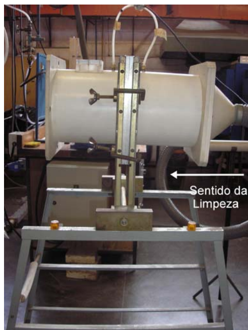
Figura 3.8: Equipamento no modo limpando.
