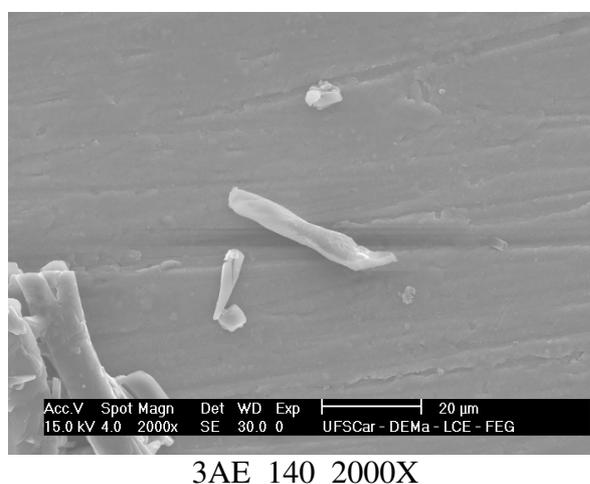
Figura 4.45- Cristais de lactose obtidos com adição de álcool etílico (pH básico)
