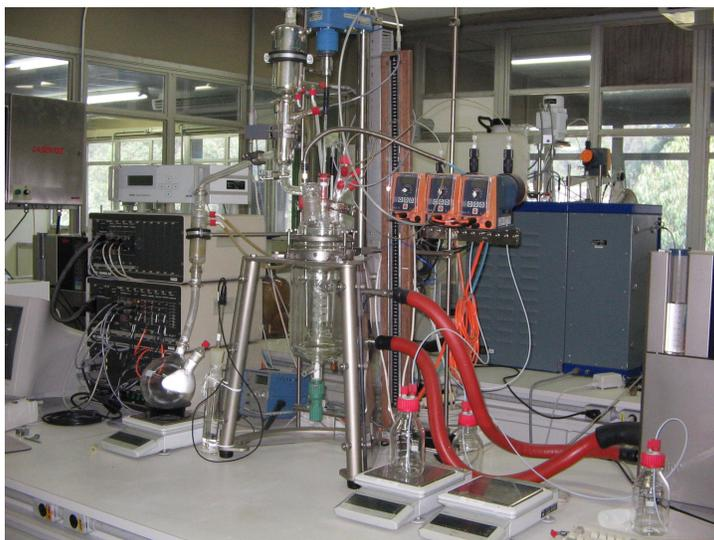
Figura 3.3 Reator automatizado SYSTAG de 2000mL.
