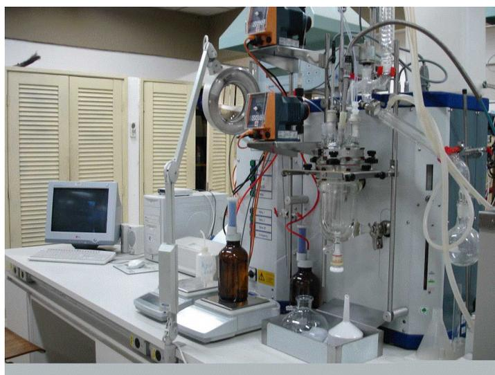
Figura 3.1 Reator Automatizado LabMax Mettler Toledo de 600 mL.
