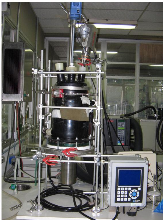
Figura 3.5 Reator automatizado IPT-Fapesp de 9000 mL.
