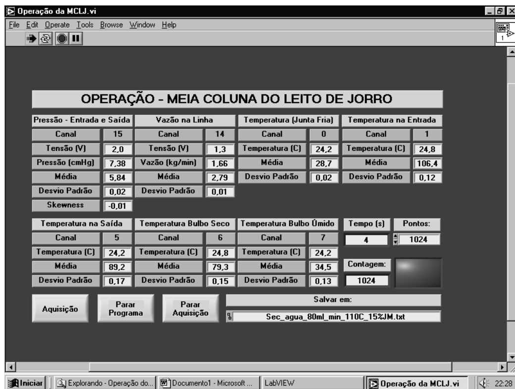
Figura 3.10 - Rotina em modo LabVIEW criada para a secagem no leito de jorro em meia coluna.
