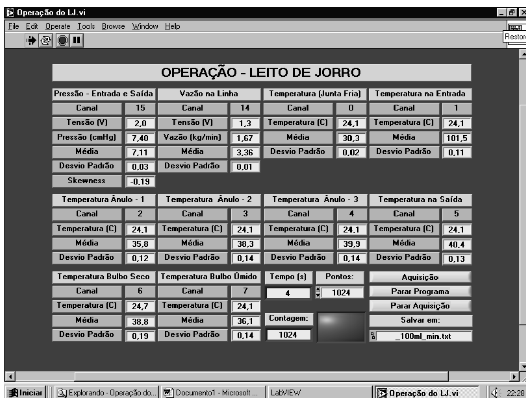
Figura 3.9 - Rotina em modo LabVIEW criada para a secagem no leito de jorro de coluna cheia.
