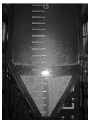
Figura 3.7 - Exemplo de imagem do leito de jorro em meia coluna obtida com o auxílio da câmera fotográfica digital.
