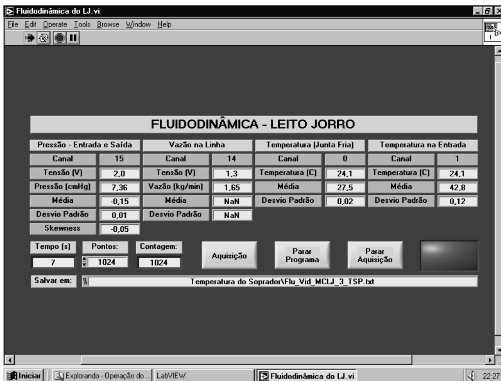
Figura 3.8 - Rotina em modo LabVIEW criada para a fluidodinâmica.
