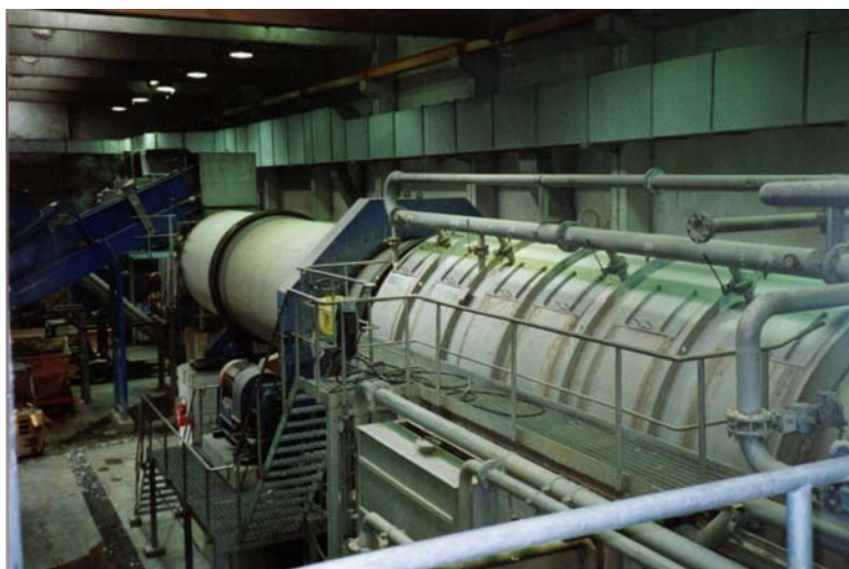
Figura 2.9 Desagregador Rotativo ou Drum Pulper (Fonte: Tetra Pak, 2001).
