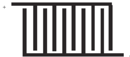
Figura 2.16 Esquema de conexão elétrica de um Reator de placas paralelas monopolar (JIANG et al. , 2002).
