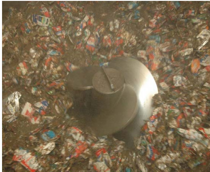
Figura 2.7 Desagregação das embalagens cartonadas multicamadas (Fonte: Tetra Pak, 2008).
