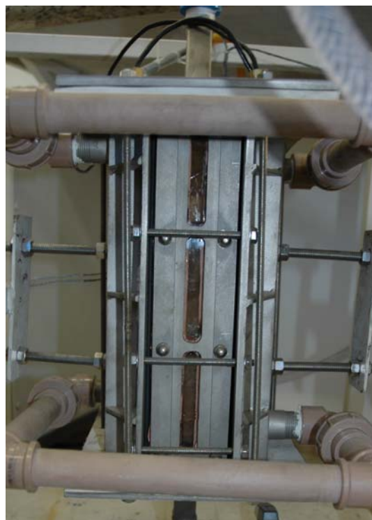
Figura 3.5 Reator eletroquímico de recirculação contínua em funcionamento.
