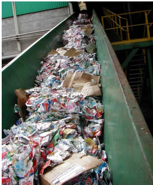
Figura 2.6 Esteira de alimentação de embalagens pós consumo no processo industrial de reciclagem (Fonte: Tetra Pak, 2008).
