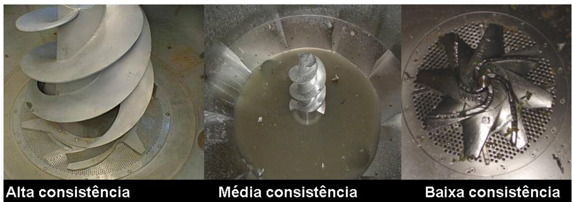
Figura 2.8 Tipos de rotores utilizados na desagregação de embalagens cartonadas multicamadas (Fonte:NEVES, 2004).
